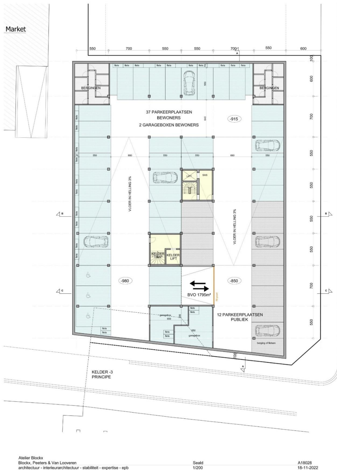
Figuur 7: Grondplan van de ondergrondse garage/kelder (niveau -3), elke verdieping heeft dezelfde oppervlakte 11
