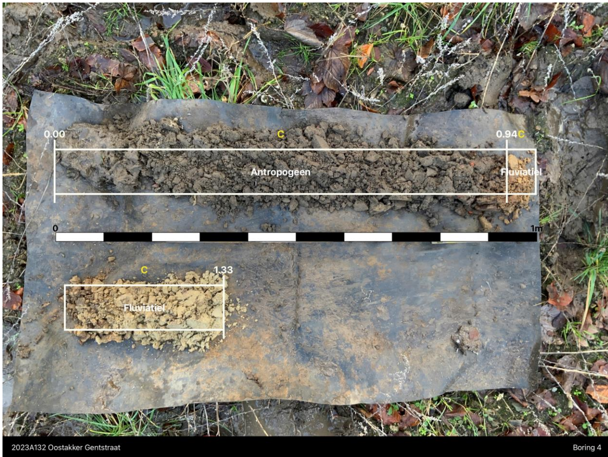
Figuur 3: Boring 4 met de aanwezigheid van een dik antropogeen (verstoord) pakket boven de oorspronkelijk afzettingen, fluviatiele afzettingen uit het Weichseliaan.
