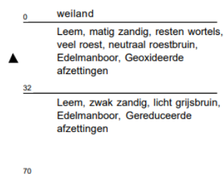
Figuur 23: Boorprofielen van controleboring 07-12. (Bron: ABO nv 2023).
