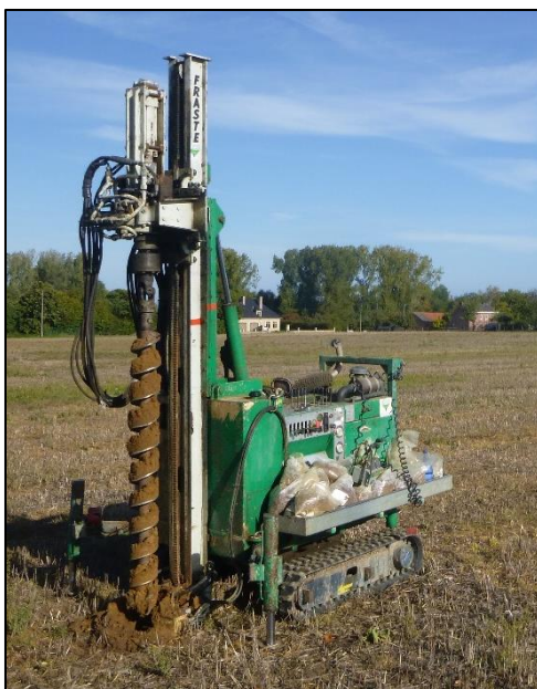
Figuur 15: De gebruikte mechanische avegaarboor. (ABO nv 2022)
