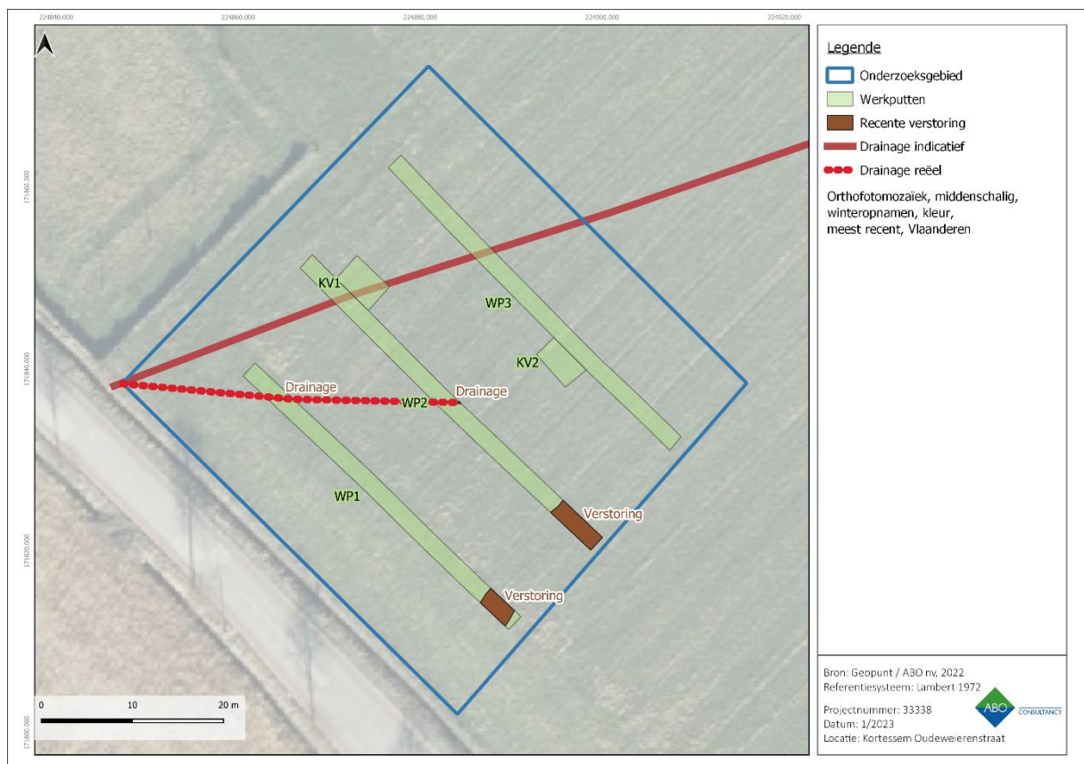
Figuur 52: Indicatieve en werkelijke ligging van de drainageleiding ter hoogte van het onderzoeksgebied.
