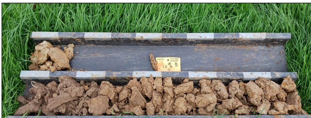
Figuur 3 : Boring 4, van 0 (linksonder) naar 110 cm (rechtsboven) onder het maaiveld.
