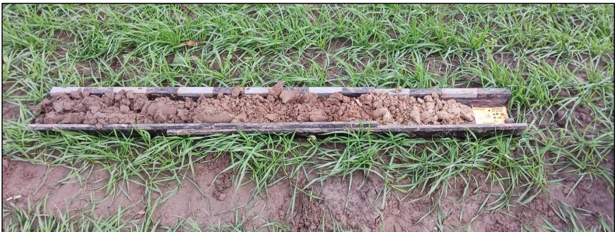
Figuur 15 : Boring 16, van 0 (links) naar 130 cm (rechts) onder het maaiveld.
