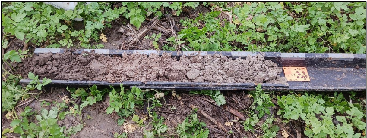
Figuur 7 : Boring 8, van 0 (links) naar 100 cm (rechts) onder het maaiveld.
