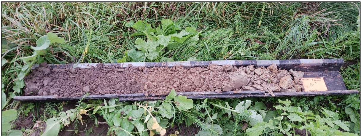
Figuur 8 : Boring 9, van 0 (links) naar 120 cm (rechts) onder het maaiveld.
