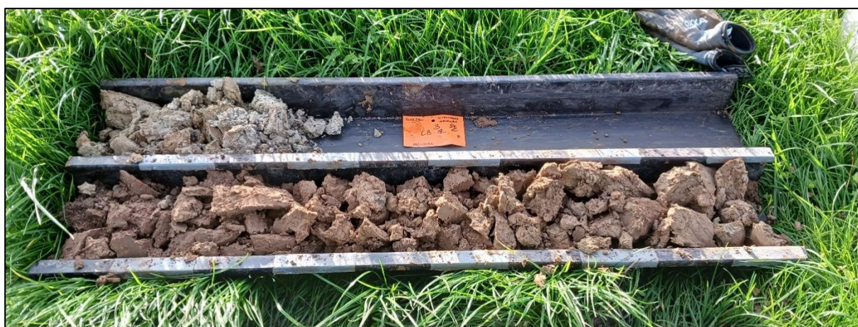
Figuur 2 : Boring 3, van 0 (linksonder) naar 130 cm (rechtsboven) onder het maaiveld.
