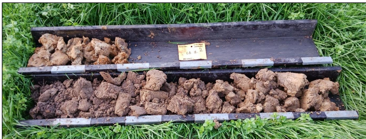
Figuur 1 : Boring 2, van 0 (linkonders) naar 130 cm (rechtsboven) onder het maaiveld.
