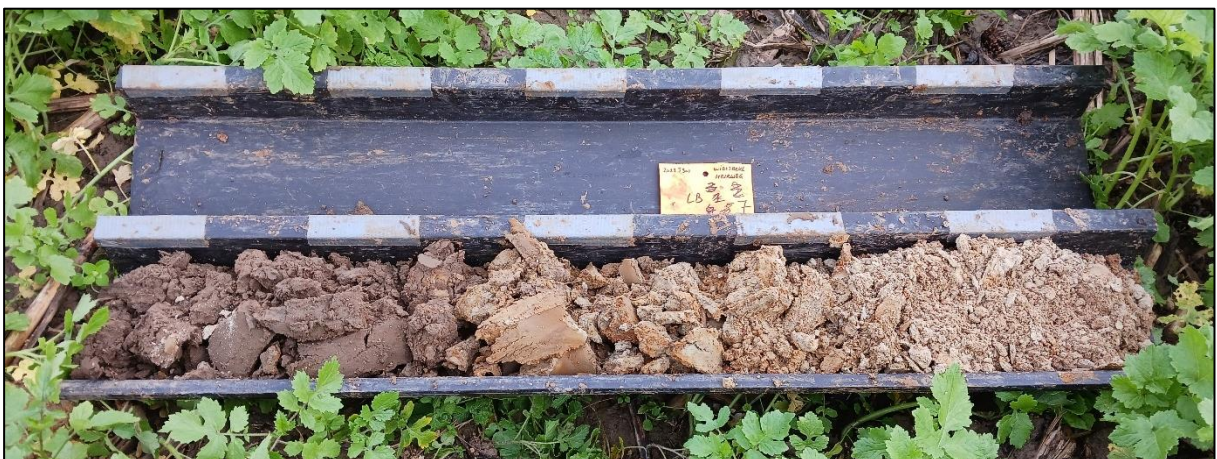
Figuur 6 : Boring 7, van 0 (links) naar 100 cm (rechts) onder het maaiveld.
