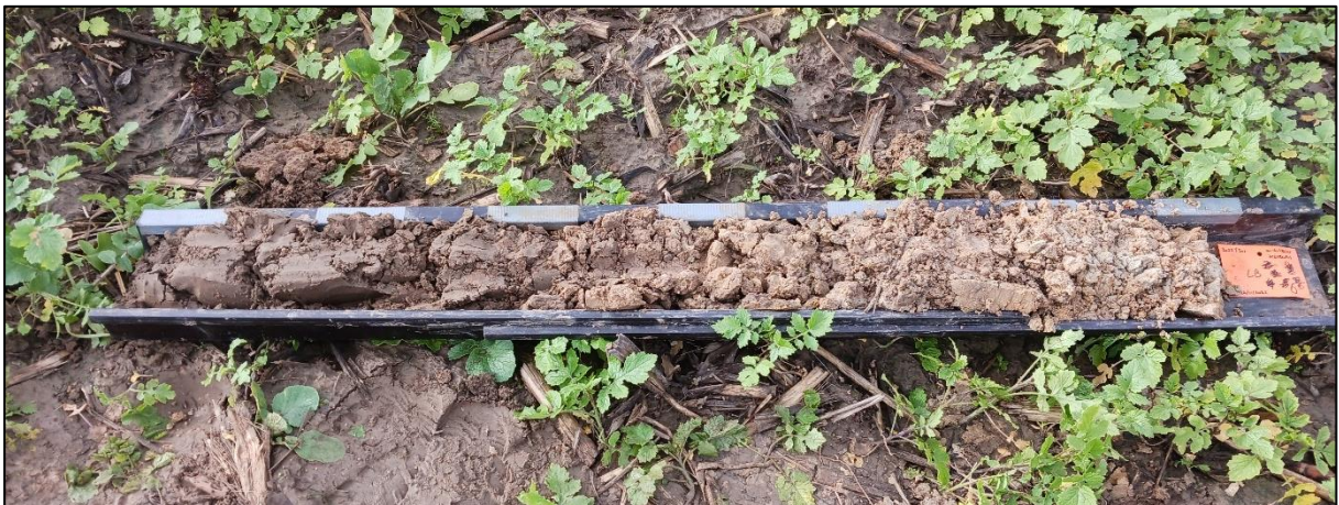
Figuur 5 : Boring 6, van 0 (links) naar 125 cm (rechts) onder het maaiveld.
