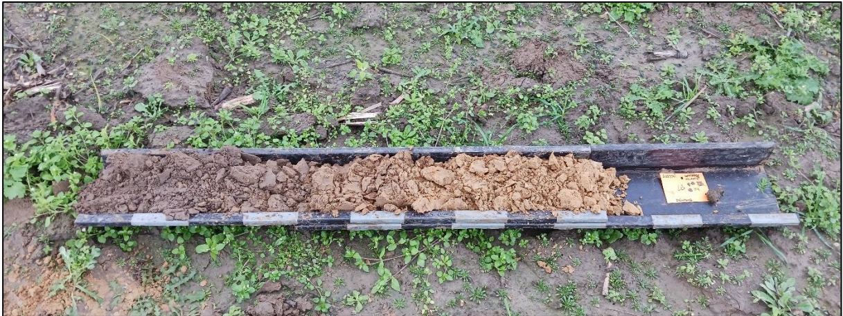
Figuur 8 : Boring 14, van 0 (links) naar 105 cm (rechts) onder het maaiveld.
