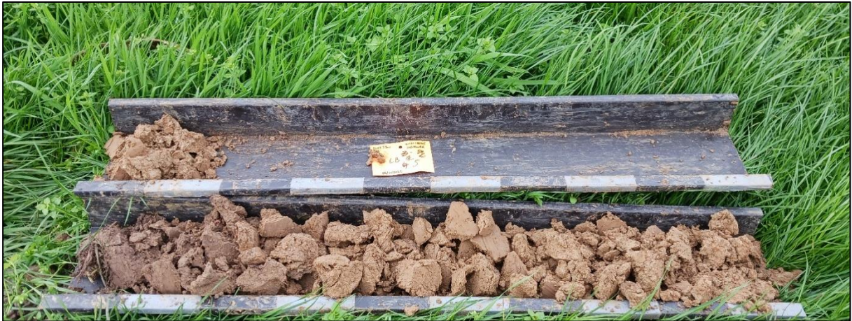
Figuur 4 : Boring 5, van 0 (links) naar 115 cm (rechts) onder het maaiveld.
