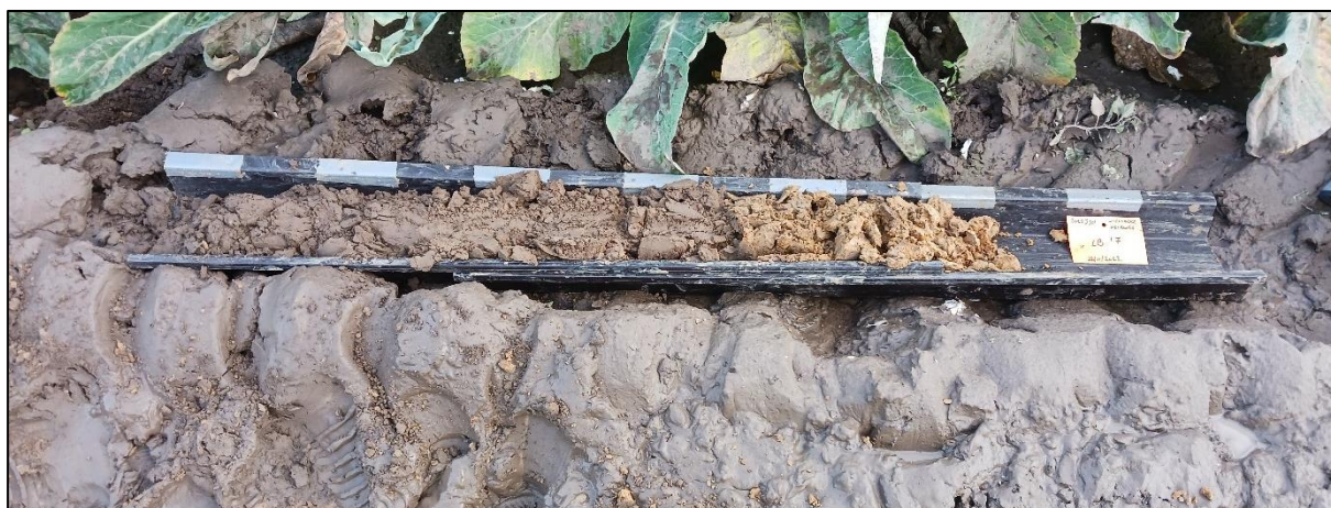
Figuur 16 : Boring 17, van 0 (links) naar 110 cm (rechts) onder het maaiveld.
