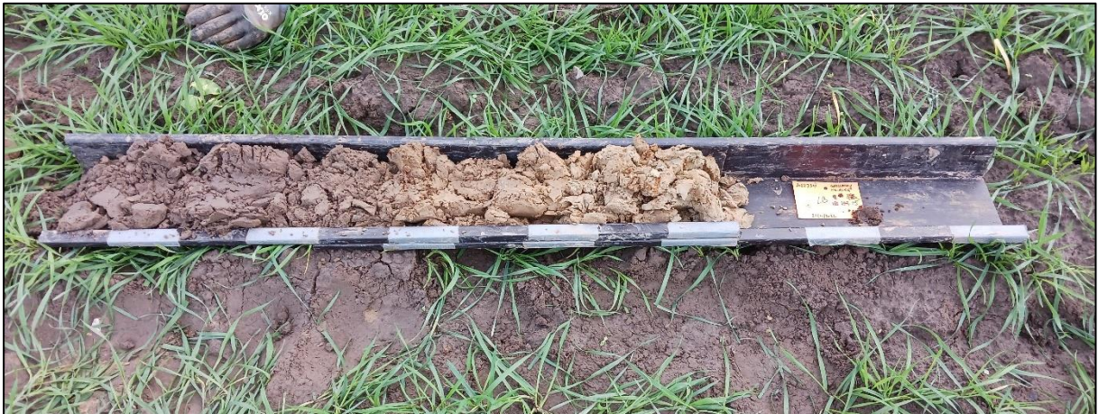
Figuur 9 : Boring 15, van 0 (links) naar 100 cm (rechts) onder het maaiveld.
