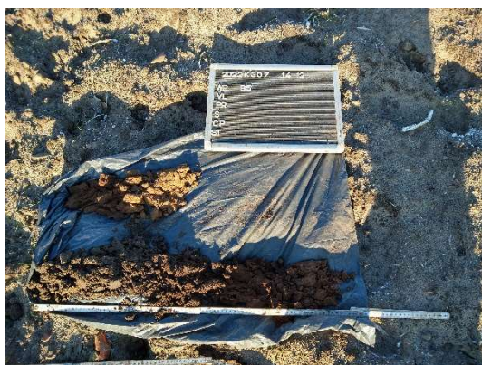
Figuur 8e. Boringen van typeprofiel 5.
