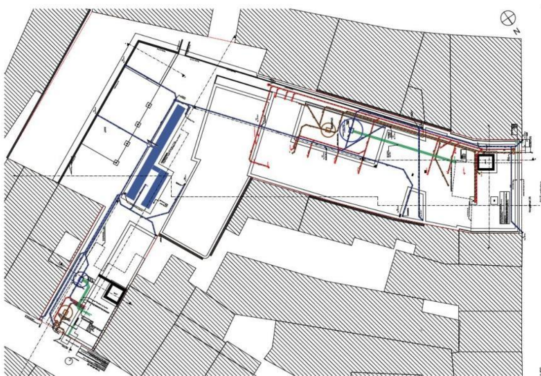
Figuur 3: Ontworpen rioleringsplan (bron: initiatiefnemer).
