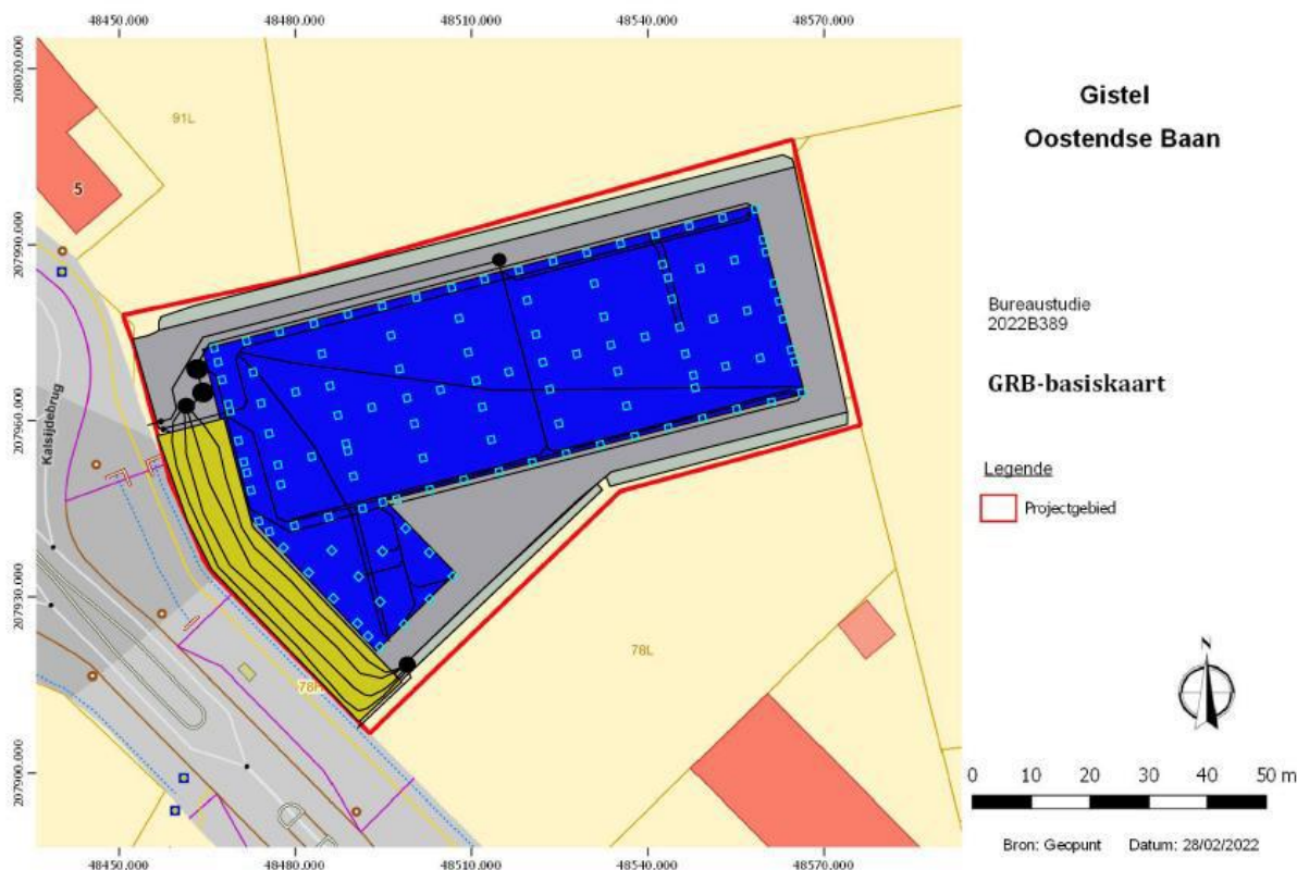
Figuur 2: vereenvoudigde weergave van de geplande werken. Legende: blauw: bedrijfsverzamelgebouw, lichtblauw: funderingszolen, geel: infiltratiezone, zwart: riolering en putten, grijs: betonverharding, lichtgroen: parking in grasdallen (Bron: Bot 2022, fig. 9).
