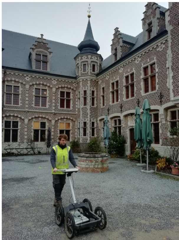
Figuur 31: Foto van de gebruikte GPR-opstelling (ABO nv, 2022).
