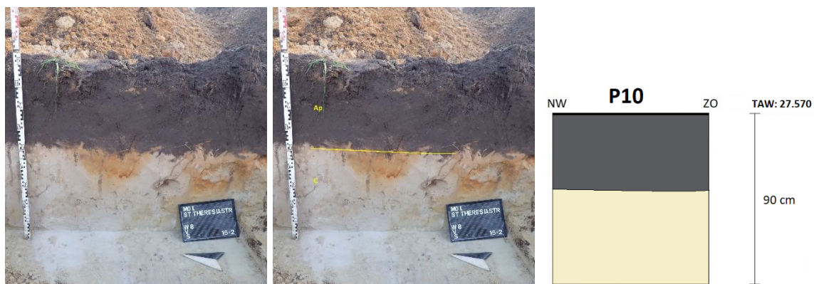
Figuur 41: Profiel P10 op foto en op tekening (© J. Verrijckt bv)
