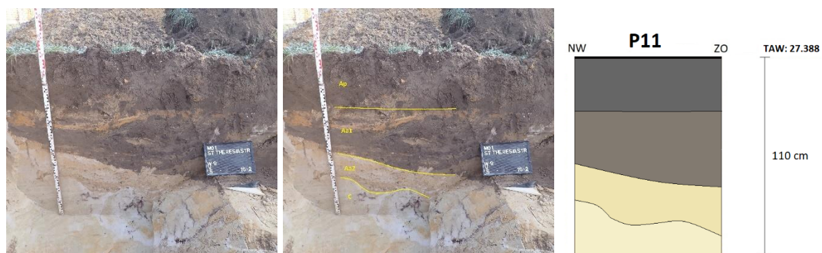
Figuur 42: Profiel P11 op foto en op tekening (© J. Verrijckt bv)
