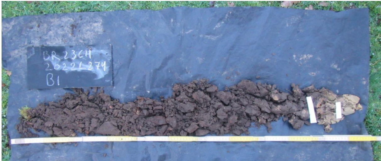
Figuur 29: Boring 1 (B1), een voorbeeld van een diep, sterk verstoord bodemprofiel
