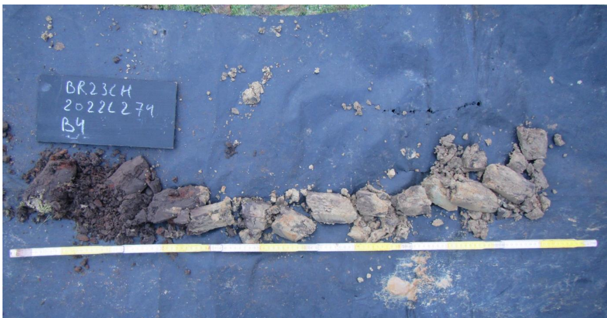
Figuur 30: Boring 4 (B4), een voorbeeld van een volledig, sterk verstoord bodemprofiel
