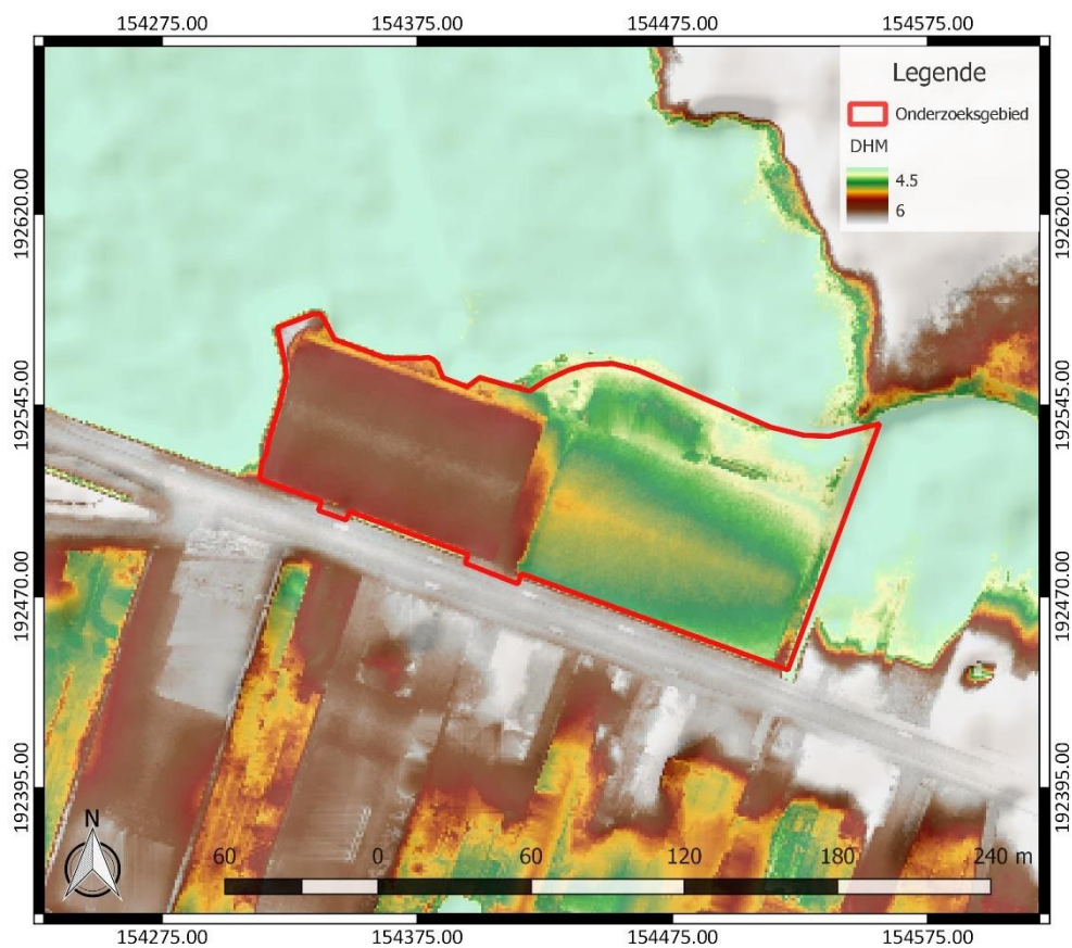
Figuur 7: Digitaal Hoogtemodel Vlaanderen II, DTM 1 m en Hillshade DHM Vlaanderen I, 5 m, met aanduiding van het onderzoeksgebied
