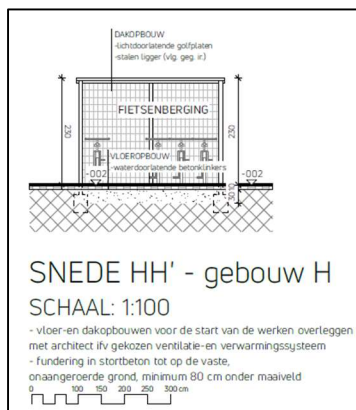
Figuur 4m. Doorsnede gebouw H.
