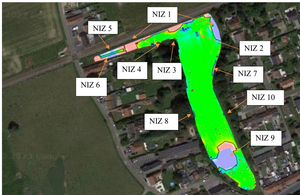
Figuur 7. Kleurenkaart van ingemeten terrein, gevoeligheid 30 nT. Tien NIZs met zwart omlijnd en individueel genummerd.
