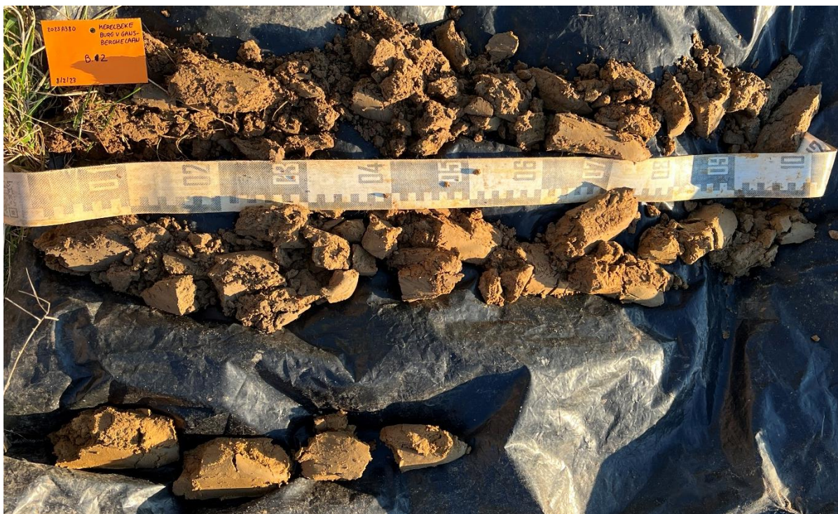
Figuur 16 : Boring 2, van 0 (linksboven) naar 250 cm (midden onder) beneden het maaiveld.
