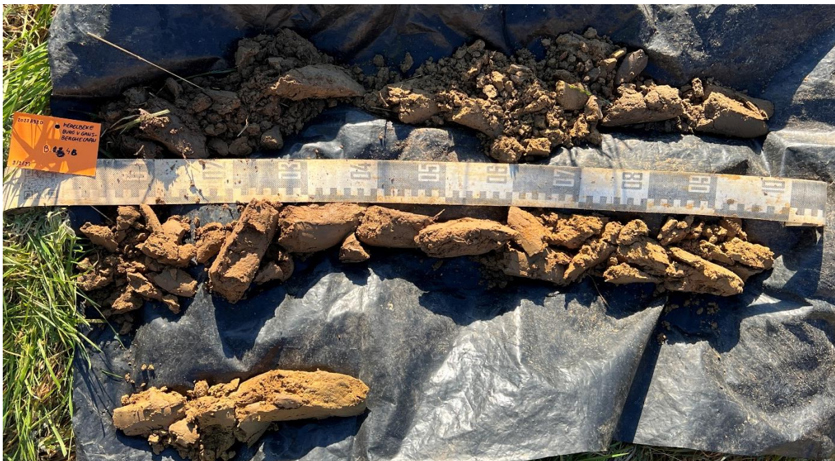
Figuur 19 : Boring 4B, van 0 (linksboven) naar 240 cm (linksonder) beneden het maaiveld.
