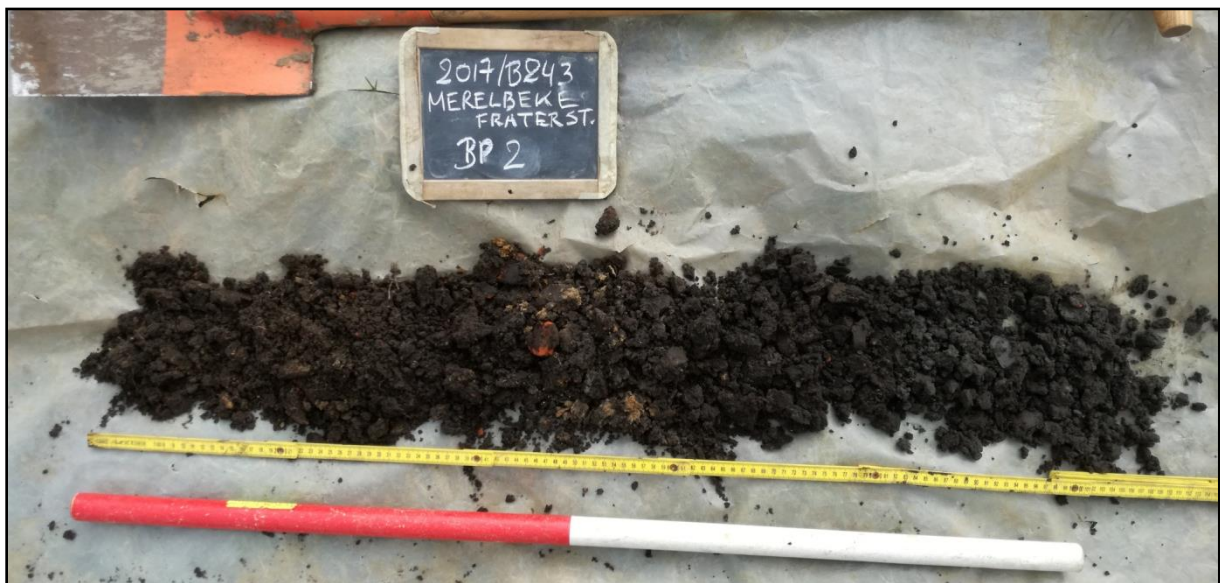
Figuur 16 Zicht op boorpunt 2 met een sterk verstoorde bodemopbouw. De andere boorpunten 3 en 4 zijn gelijkaardig aan deze boring.
