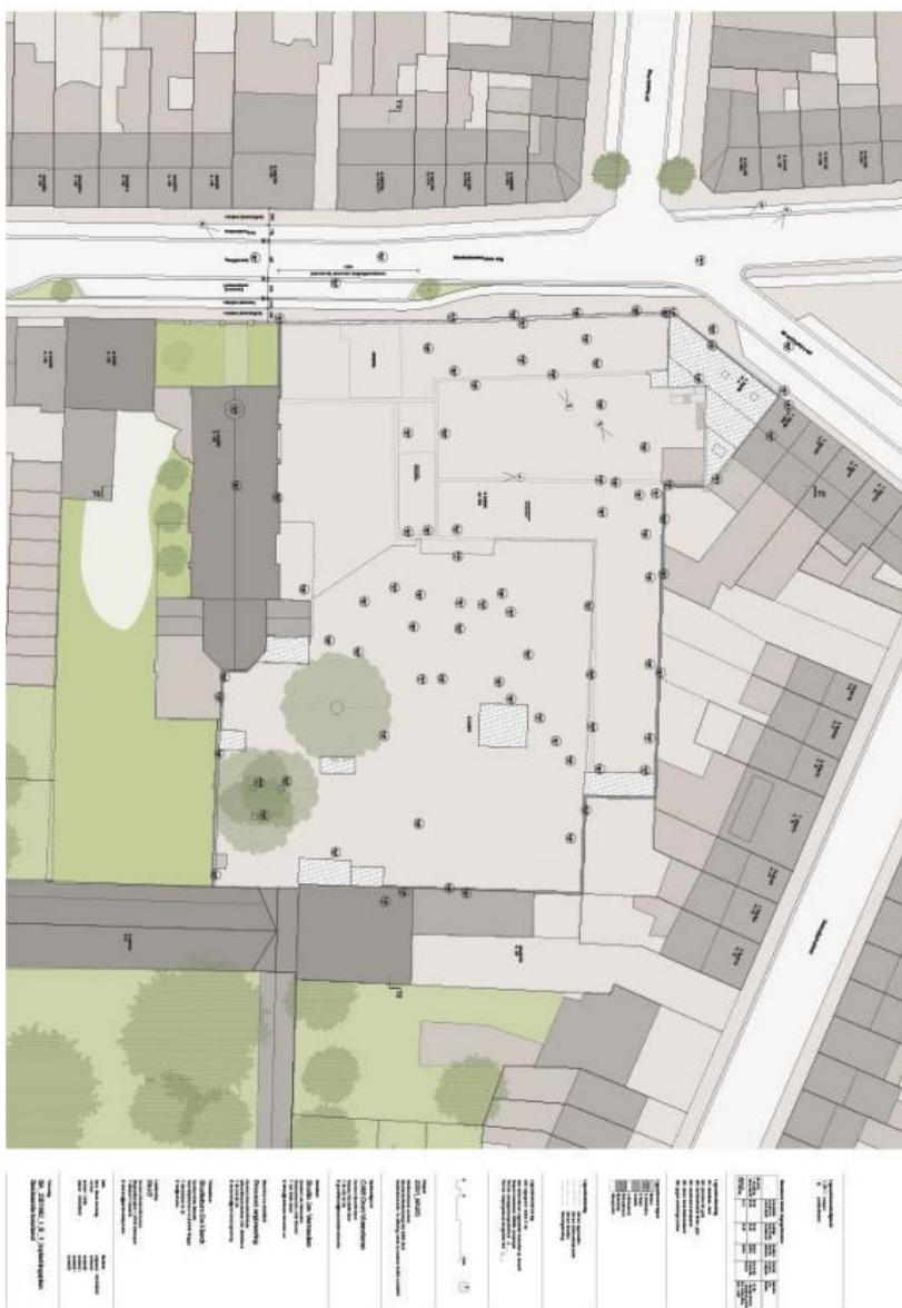
Figuur 1: bestaande toestand inclusief de ondergrondse funderingen van het 19e eeuwse klooster (Bron: opdrachtgever).
