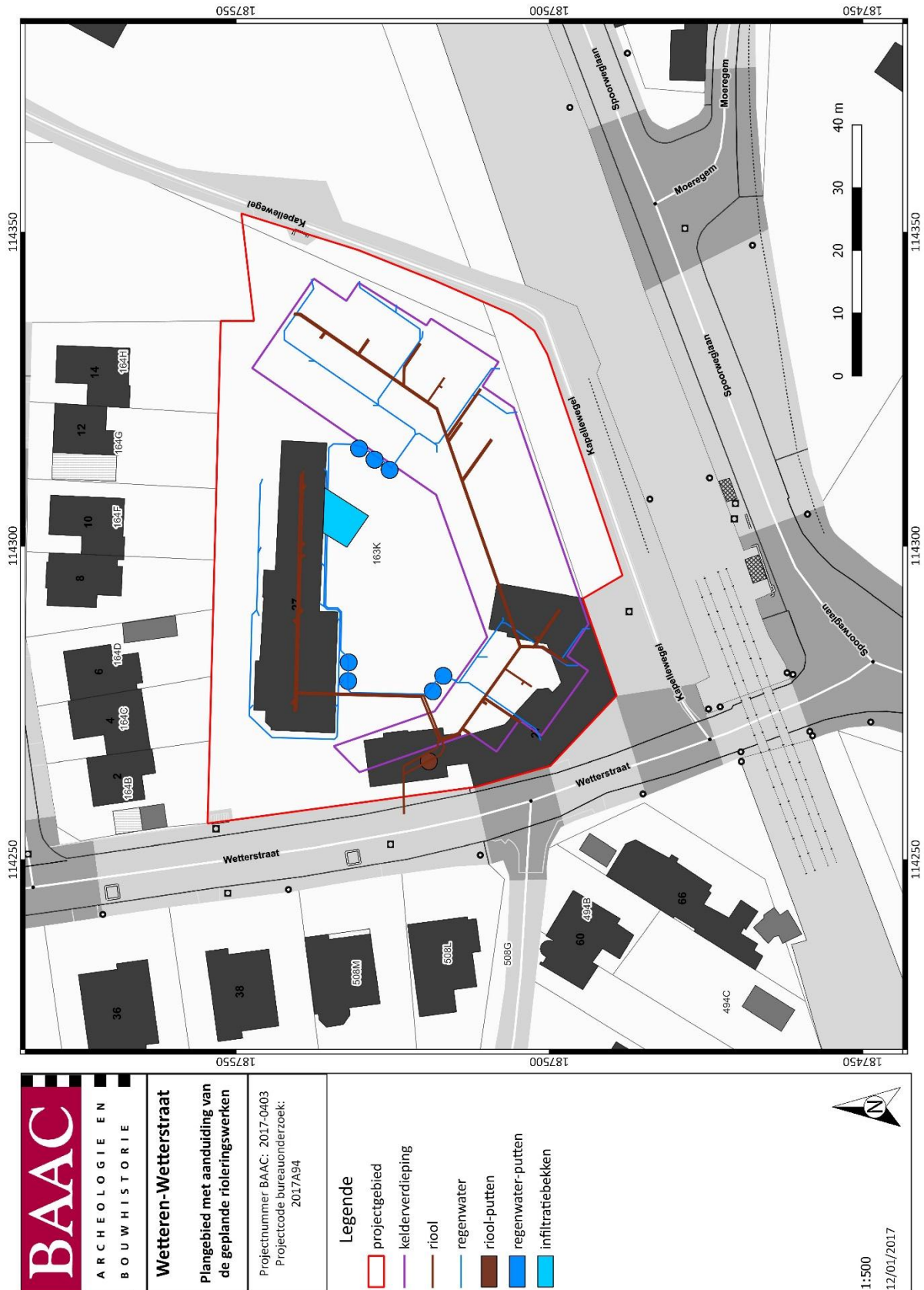
Figuur 10: Geplande rioleringswerken binnen het projectgebied.
