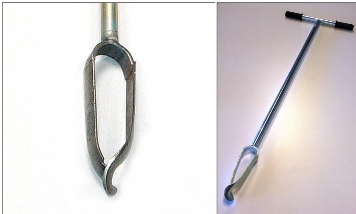
Figuur 39: Combiboor met een diameter van 7 cm (Bron: http://www.eijkkamp.com en http://www.wrm.nl )
