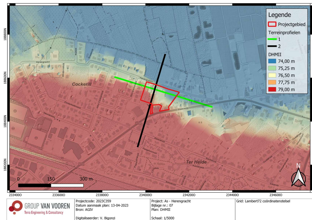
Fig. 1.10: Gedetailleerd digitaal hoogtemodel (DHM II) met situering van het projectgebied met terreinprofiel 1 (W-O) en 2 (N-Z) (© AGIV).
