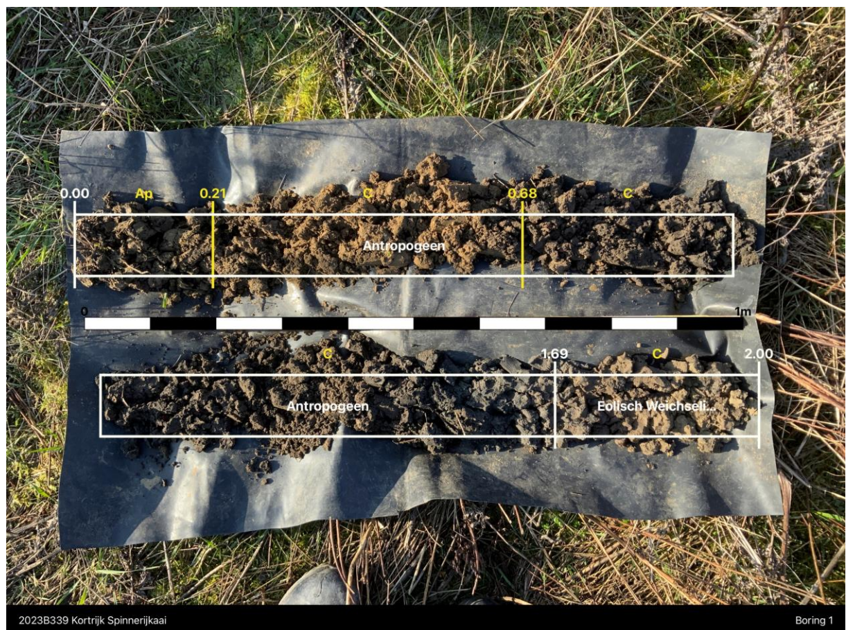
Figuur 6: Boring 1 met een dikke verstoorde top en in de basis de eolische afzettingen.
