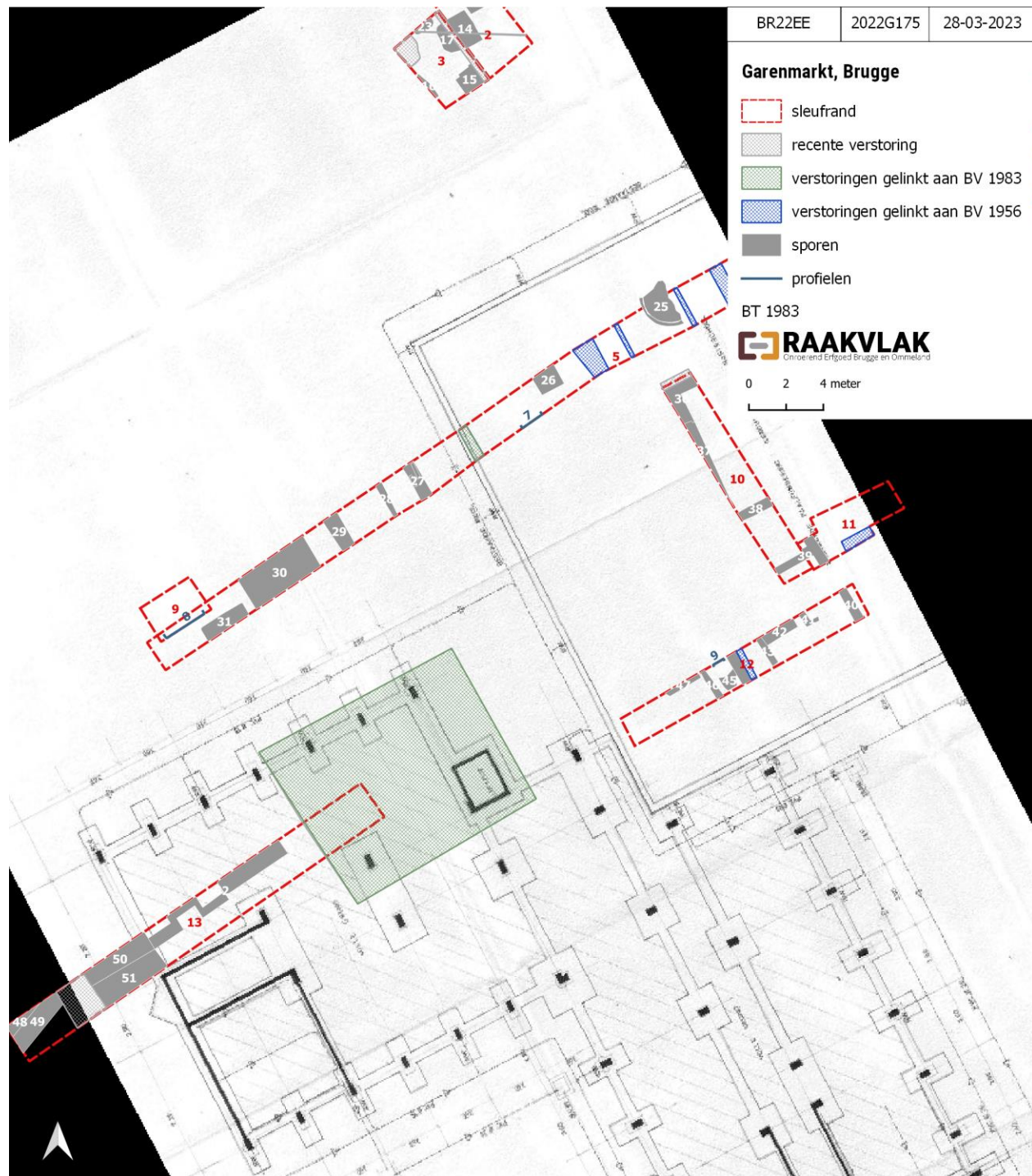
Figuur: overlay van bouwvergunning schoolvolume uit 1983 (detail westzijde) op het allesporenplan van de zuidelijke fase. De recente muren en verstoringen die overeenkomen zijn in het blauw en grijs gearceerd. Bemerk dat de recent vergraven zone tussen sleuf 12 en 13 overeenkomt met een liftput en enkele zware betonmassieven.
