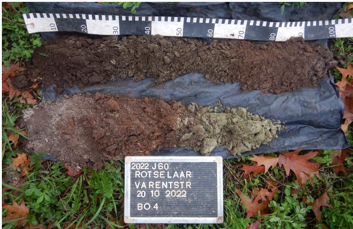
Figuur 6: Boorprofiel 4 met de bovenzijde linksboven en de onderzijde rechtsonder
