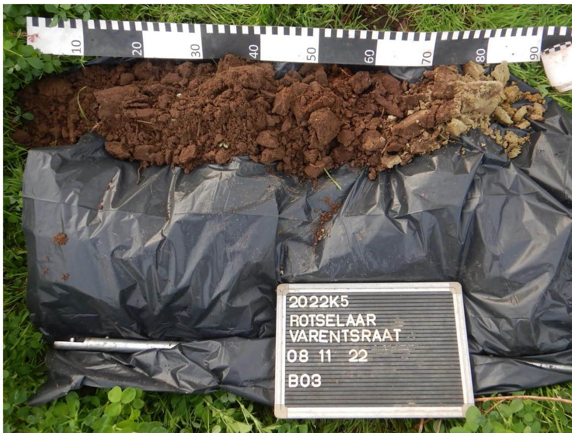
Figuur 17: Boorprofiel 3 met de bovenzijde links en de onderzijde rechts
