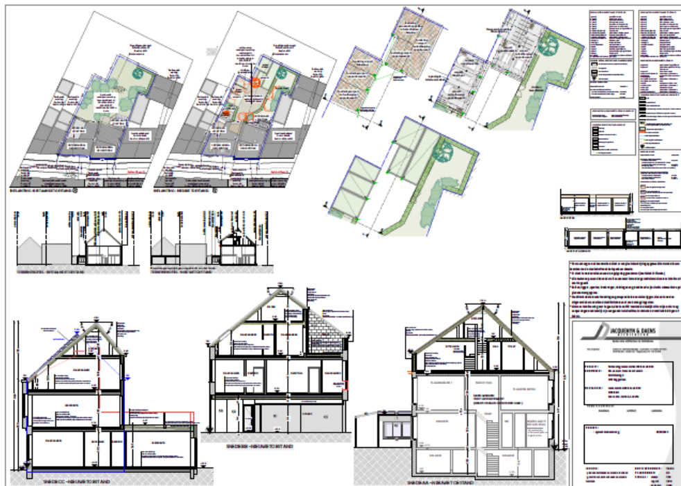
Figuur 10: Inplanting nieuwe toestand met doorsnedes. (Opdrachtgever, 2023).
