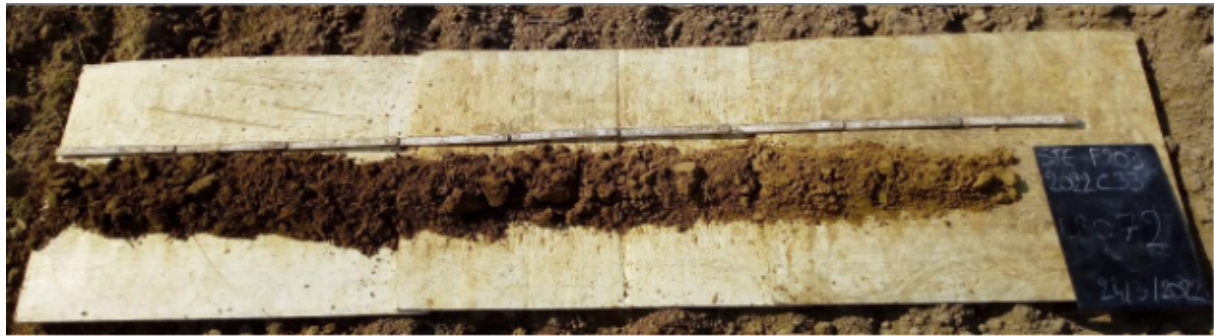
Fig. 1.27: Meest voorkomende profiel (Ap-Ac-C) 24 .
