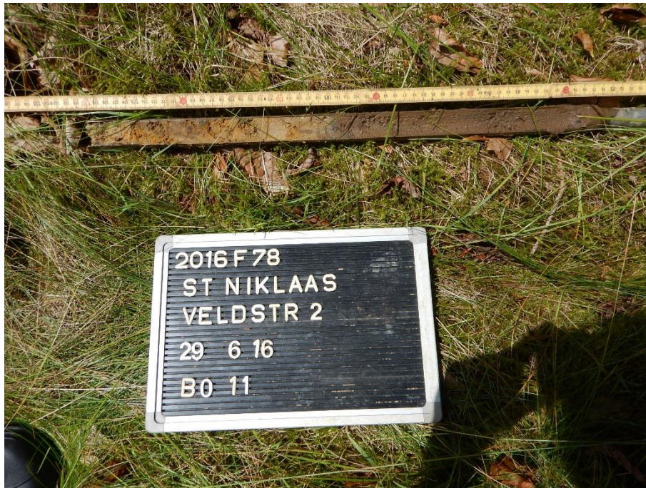
Figuur 22: Foto van boorprofiel 11 met de Aa horizont (rechts) en de C horizont (links)
