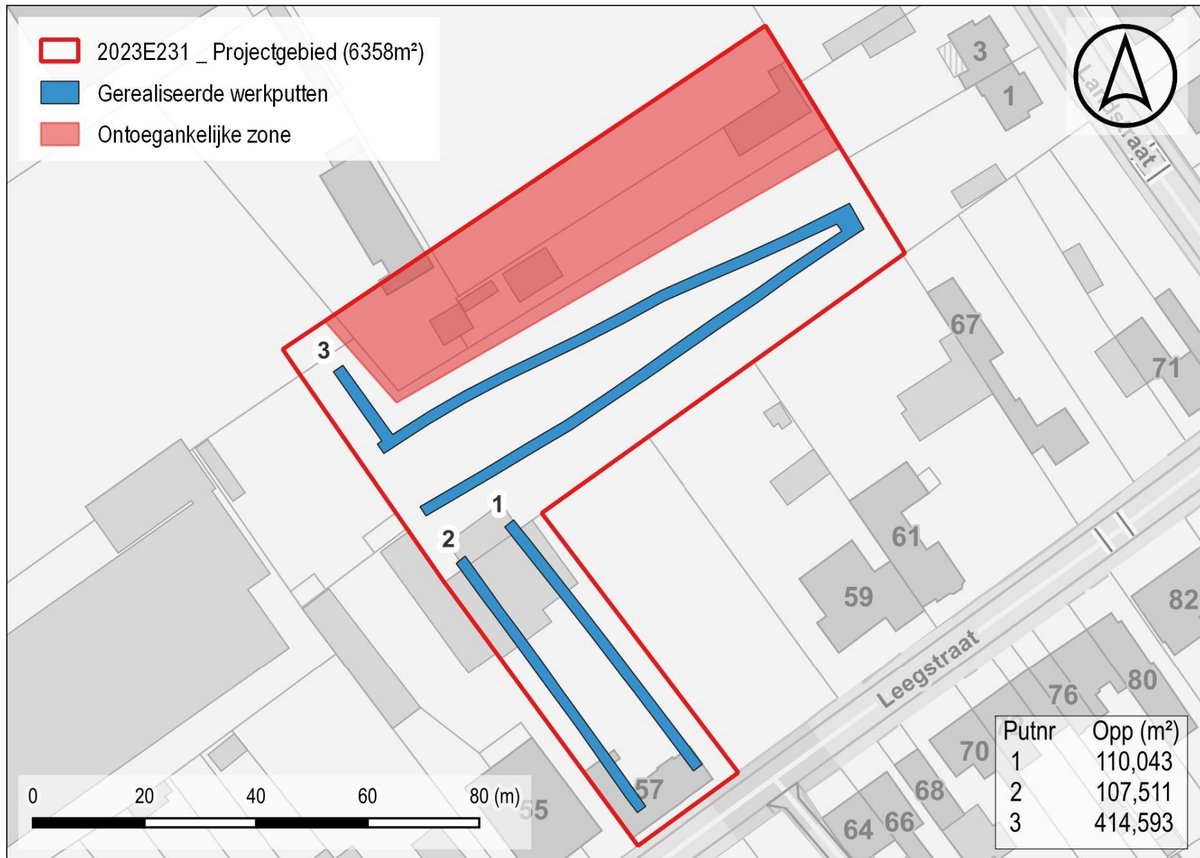
Figuur 16: Overzicht gerealiseerde werkputten met aanduiding zone met terreinobstructie
