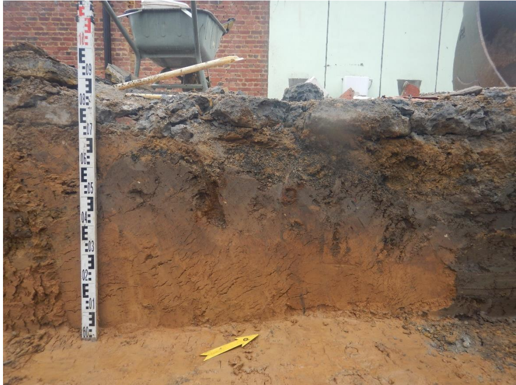
Figuur 29: Fotoreportage P6 WP6 als illustratie zeer lokale bewaring van onvolledige Bs-horizont op scheidingsvlak tussen antropogene top [A] en natuurlijke leem [C] (boven); P9 in kasteelzone waarbij de grijze verkleuring van het natuurlijk sediment uitsluitend te relateren is aan fluctuaties in in tijdelijk grondwater rondom aangetroffen muurdelen (onder)
