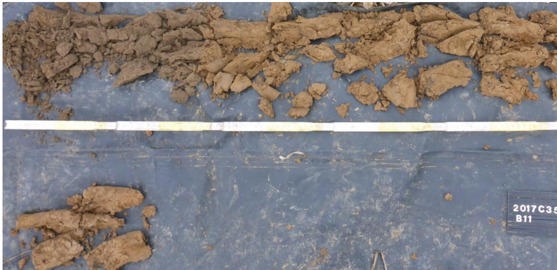
Figuur 25: Boring B11 met onduidelijk gemarkeerde B-horizont.
