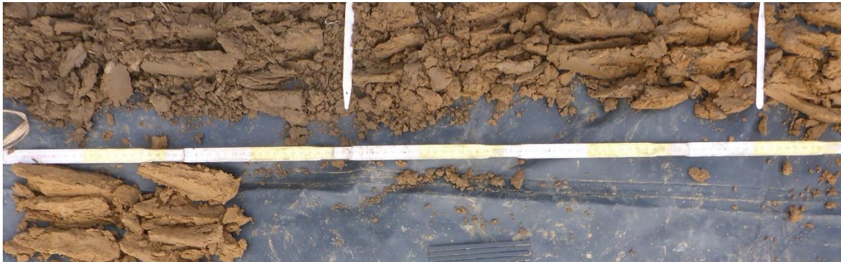
Figuur 24: Boring B5 met duidelijk gemarkeerde B-horizont.
