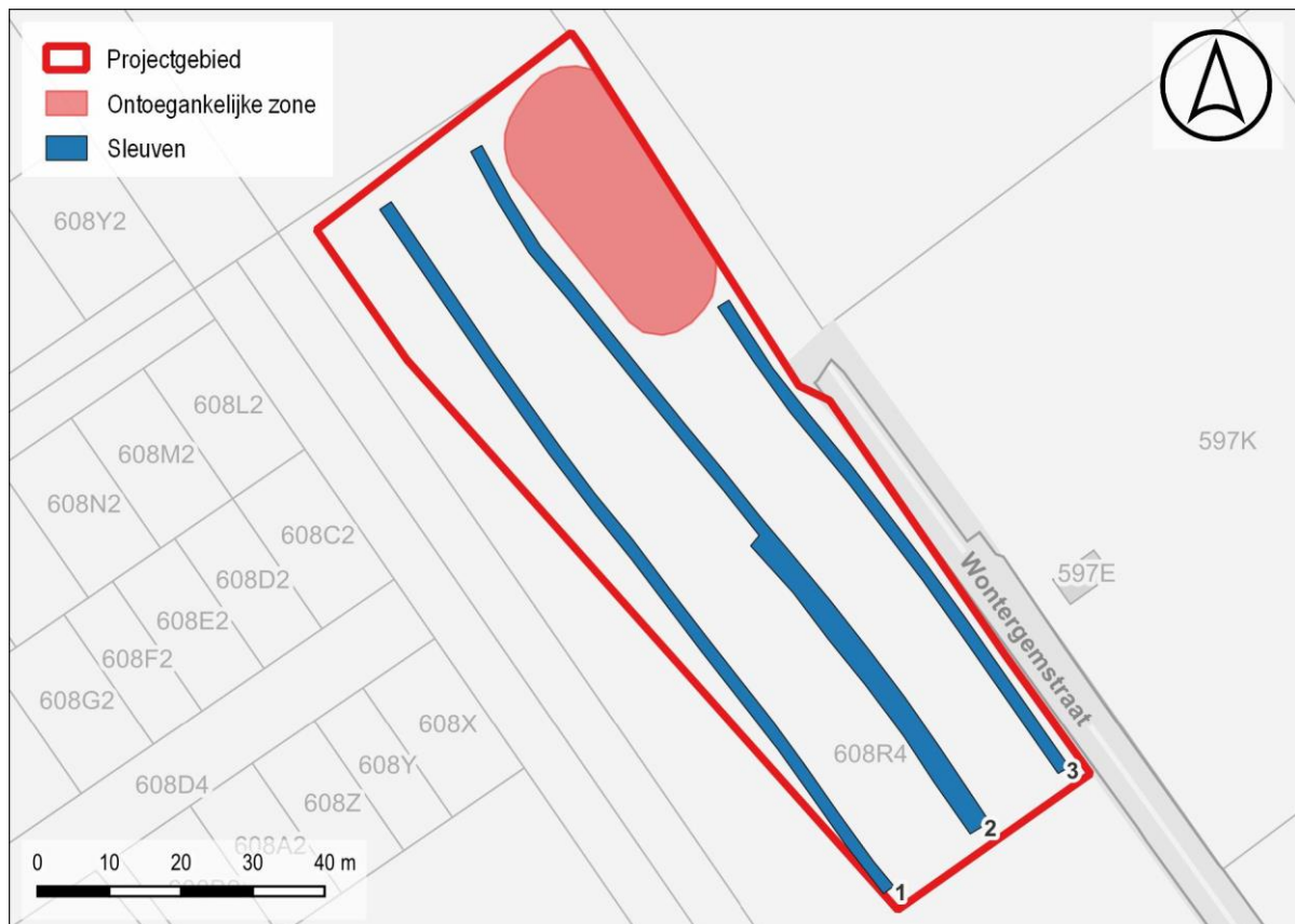
Figuur 2: plan met projectie van de drie proefputten tov kadaster (@Geopunt).
