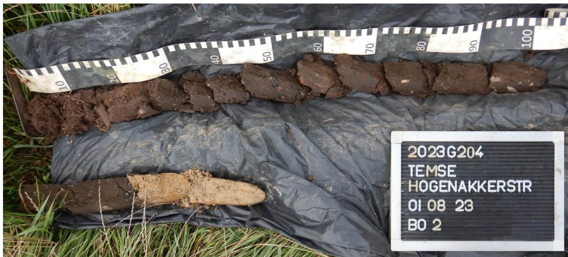
Figuur 7: Boorprofiel 2 met de bovenzijde links en de onderzijde rechts
