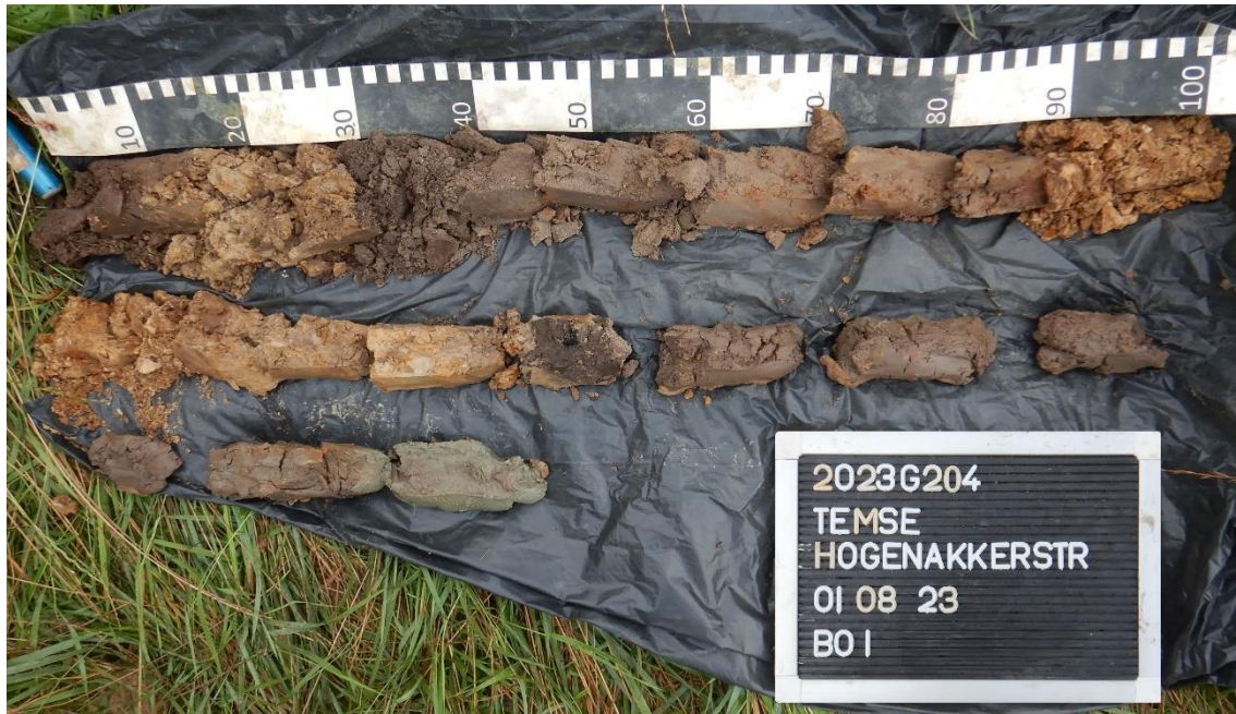
Figuur 6: Boorprofiel 1 met de bovenzijde links en de onderzijde rechts
