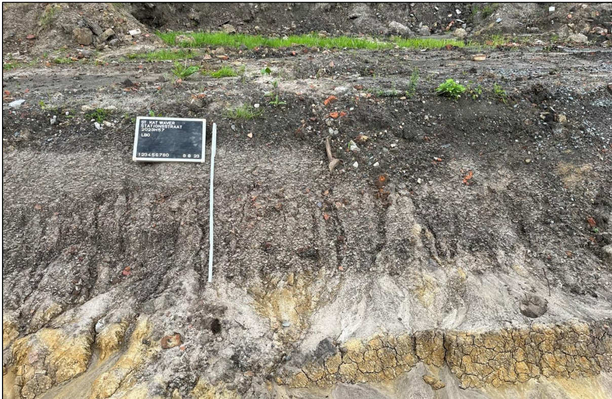
Figuur 22: De aanwezige puinlaag aan de noordzijde van de uitgraving, ter hoogte van boring 5.
