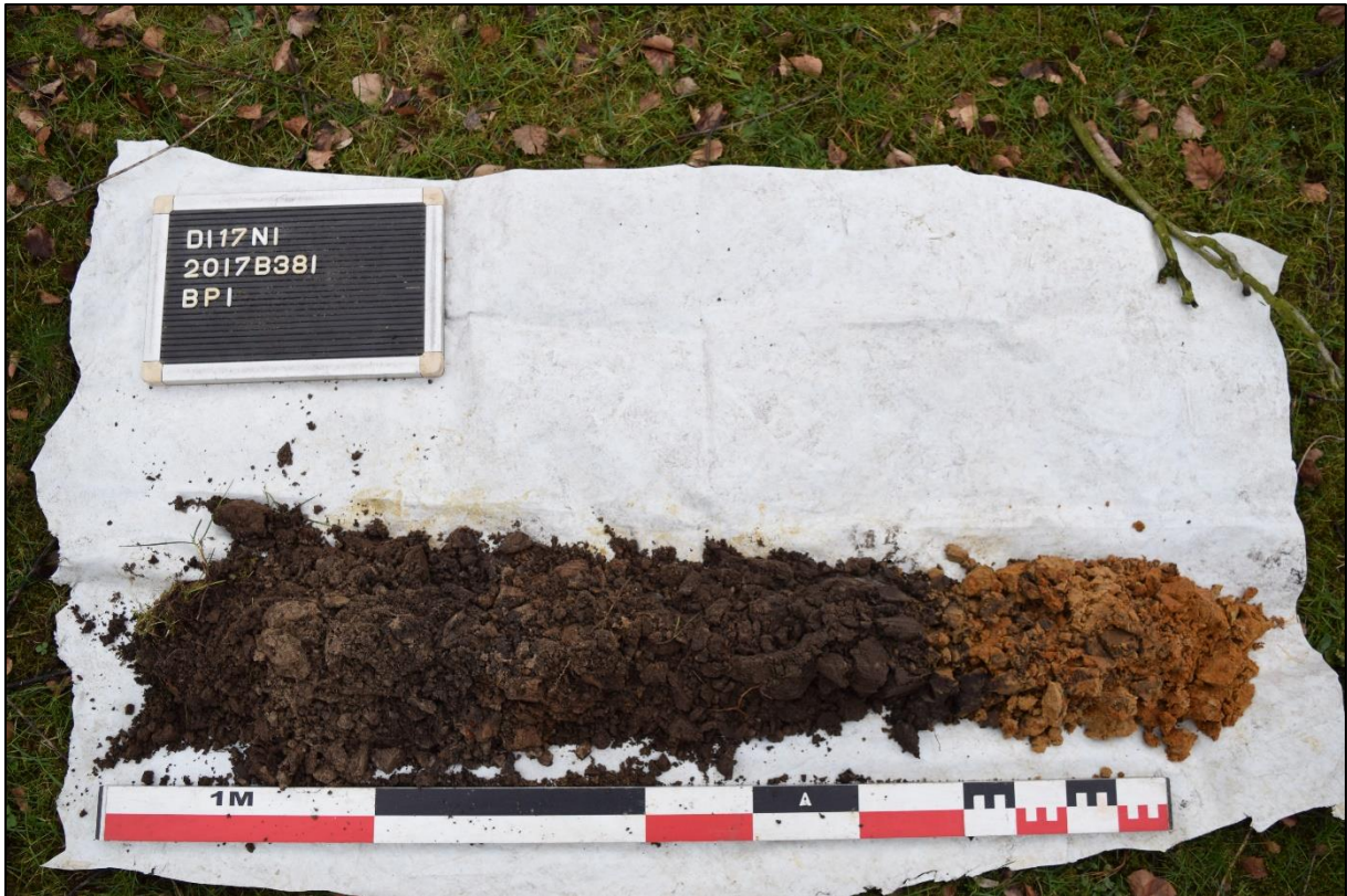
Afb. 25: BP 1 met horizonten Ap' – Bh – Cg (Bron: Aron bvba, dd. 28/02/2017, 2017B381)
