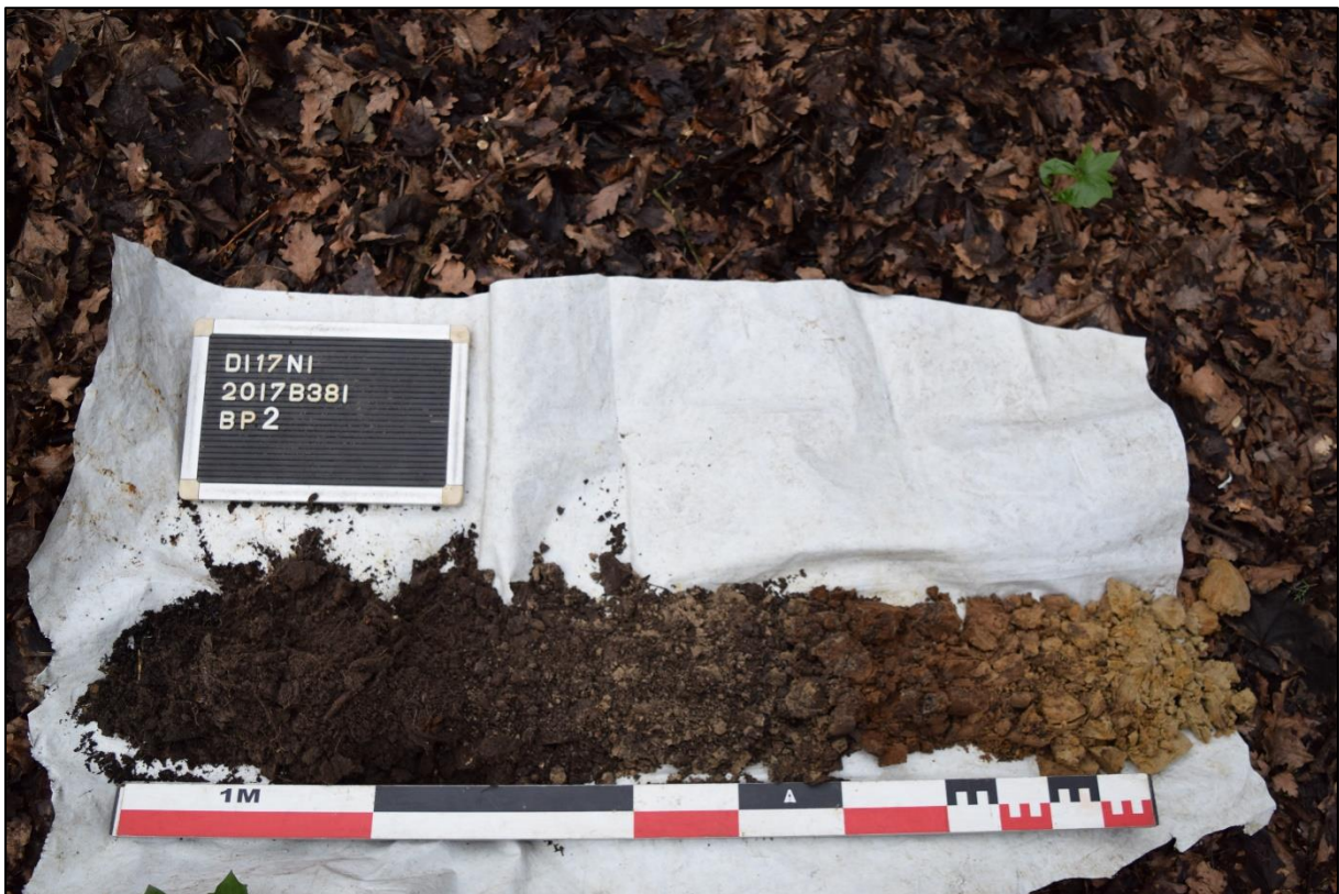
Afb. 26: BP 2 met horizonten Ap – E – Bs – Cg (Bron: Aron bvba, dd. 28/02/2017, 2017B381)
