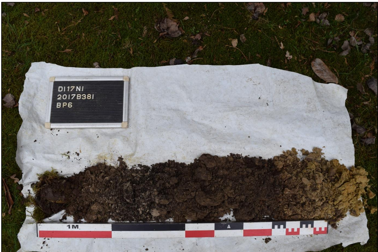
Afb. 30: BP 6 met horizonten Ap' – Bh – Cg (Bron: Aron bvba, dd. 28/02/2017, 2017B381)
