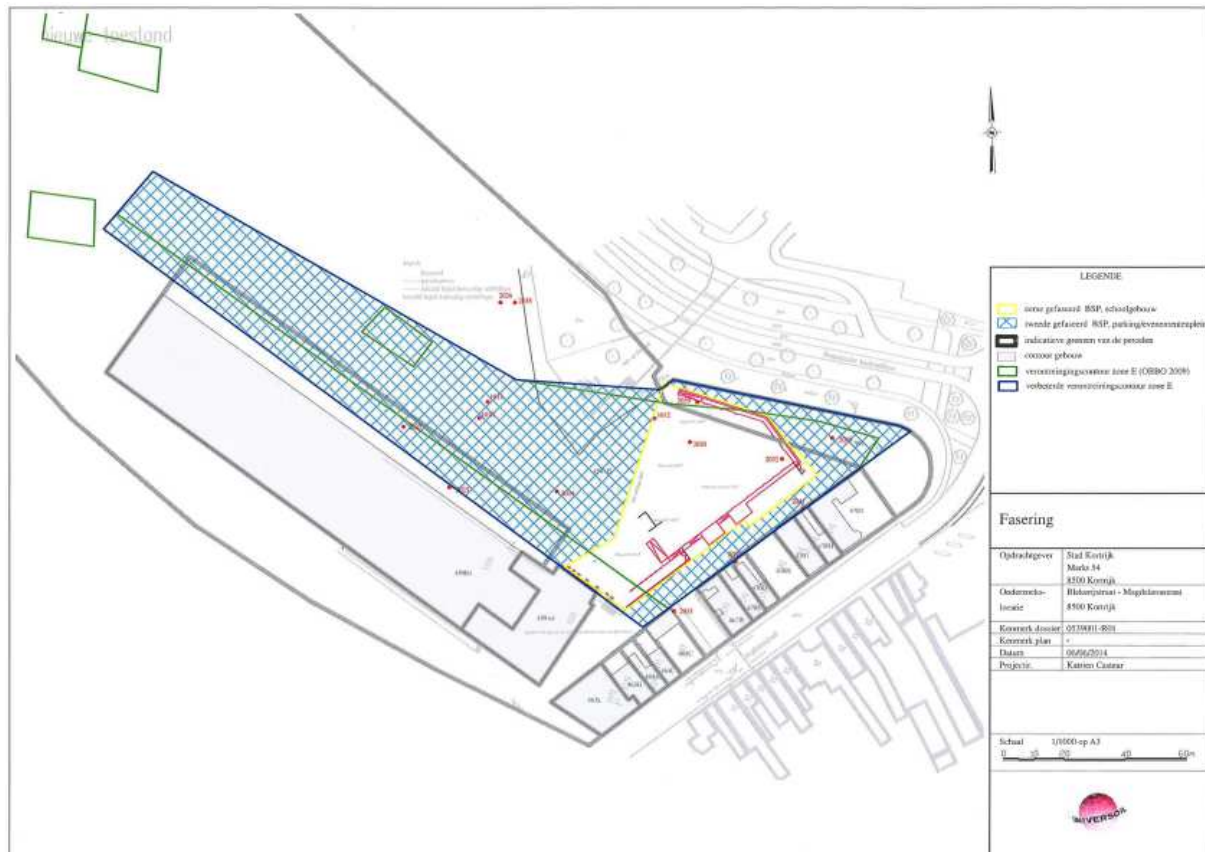
Figuur 13: Kaart met de onderzochte zone uit 2014. De gele zone is de ontgravingszone voor de bodemsaneringswerken onder het schoolgebouw voor het CVO. De blauw omlijnde zone vormt de afbakening van verontreinigingszone E (bron: Universoil 2014).
