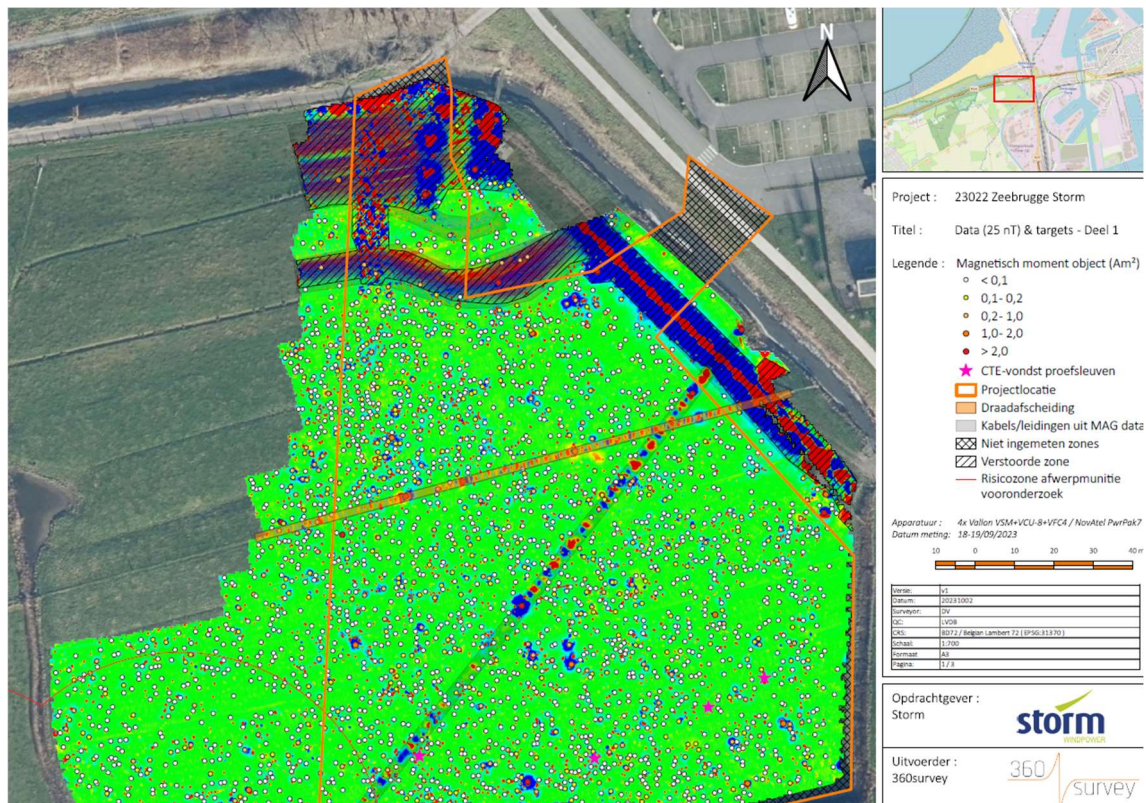
Fig. 2.5: CTE-onderzoek met aangetroffen objecten en CTE-vondsten uit het proefsleuvenonderzoek (@ 360Survey 2023).
