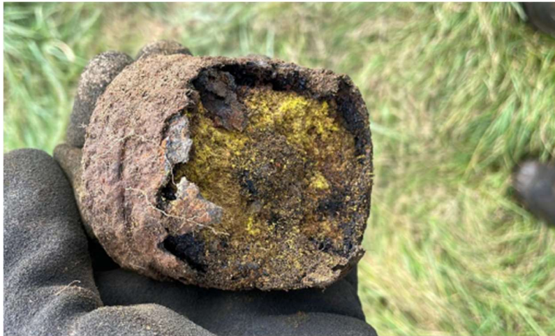
Fig. 2.25: Duitse handgranaat met blootliggend kristallijn explosief (© 360survey 2023, fig.4).
