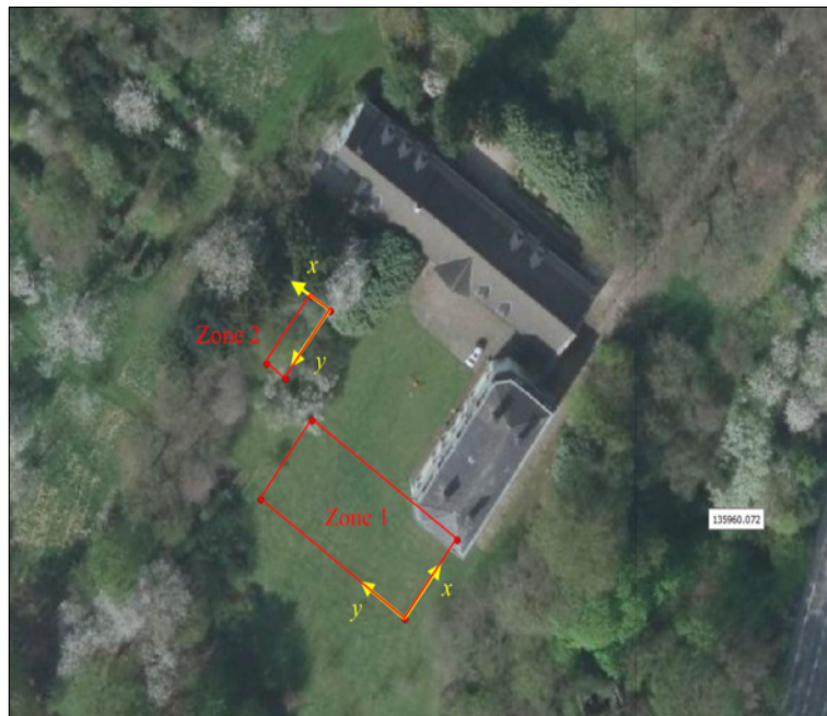
Fig. 1.4: Weergave van de zones van het GPR-onderzoek (bron: Sensor Consulting).
