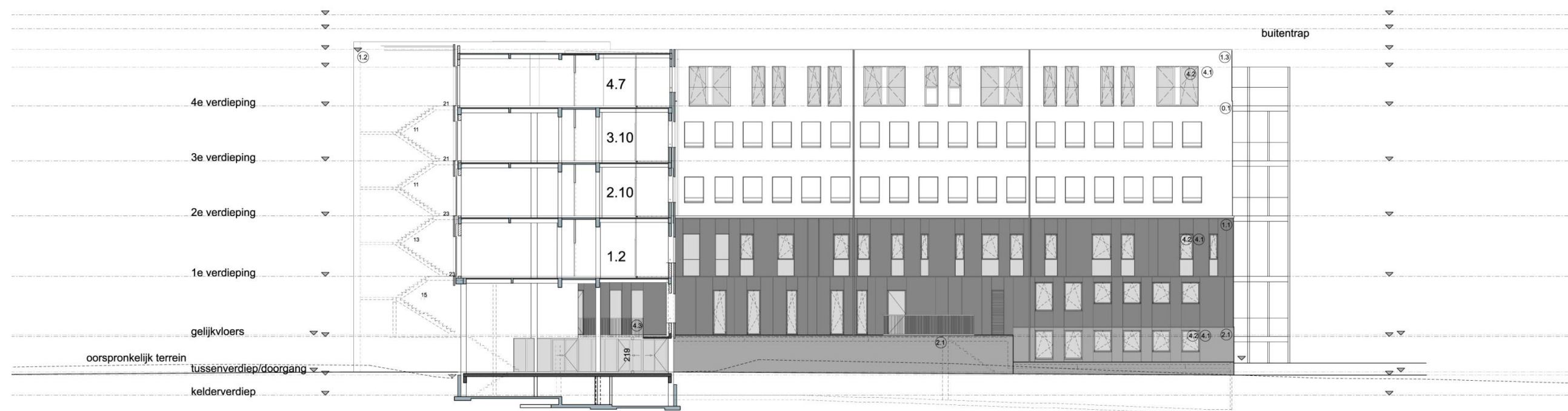
Figuur 10: Doorsnede ontworpen toestand (AMV architecten)
