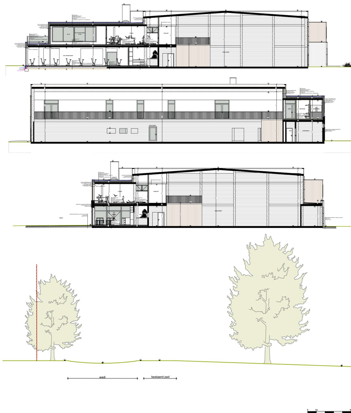
Figuur 4. Doorsnede fitnessruimte, terras en wadi.
