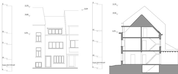
Afbeelding: Snede van een woning op basis van een laserscan, uitgetekend met een beperkt detailniveau. © RealVisuals.
