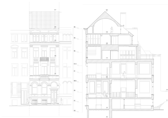
Afbeelding: Snede van een woning op basis van een laserscan, uitgetekend met een hoog detailniveau. © RealVisuals.
