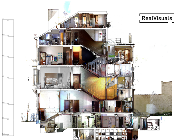
Afbeelding: Snede van een woning op basis van een laserscan, uitgetekend met een hoog detailniveau gecombineerd met orthofoto's. © RealVisuals.
