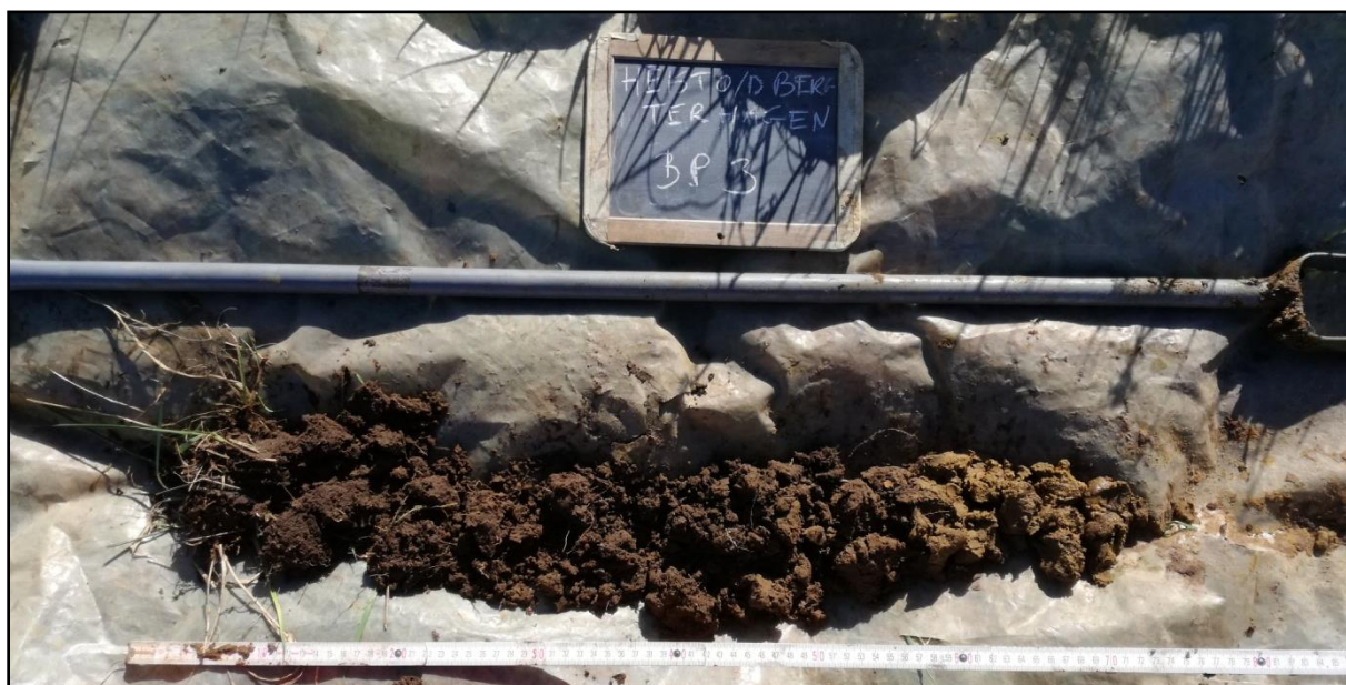
Figuur 17 Zicht op de controleboring BP3 in het zuidwestelijke deel ter hoogte van gebouw C.
