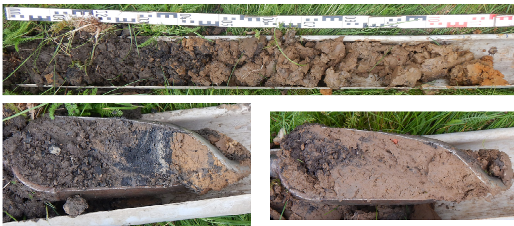
Figuur 28. Controleboring 1. Onder: de overgang van de sintelrijke aanvulling naar de onderliggende puinhoudende aanvulling (rechts).
