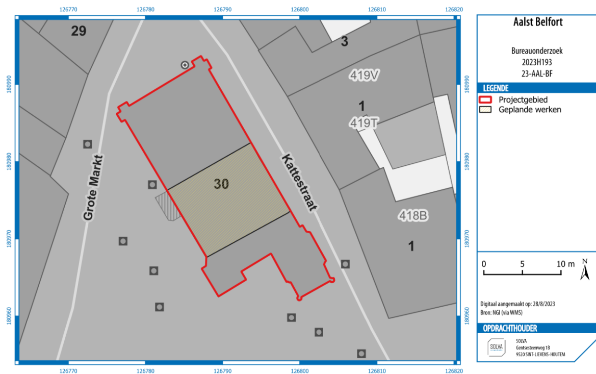
Figuur 6 syntheseplan met aanduiding van de zone van de geplande werken
