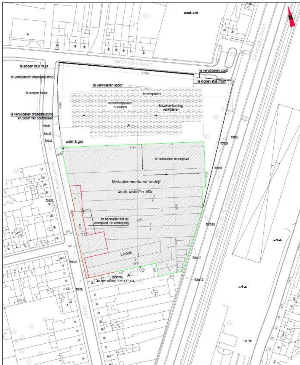
Figuur 4: Toestand voor de sloop van de bebouwing. Het gedeelte dat in groen omlijnd is werd ondertussen gesloopt. Het gedeelte dat in rood omlijnd is werd behouden. (Bron: Opdrachtgever 2017)
