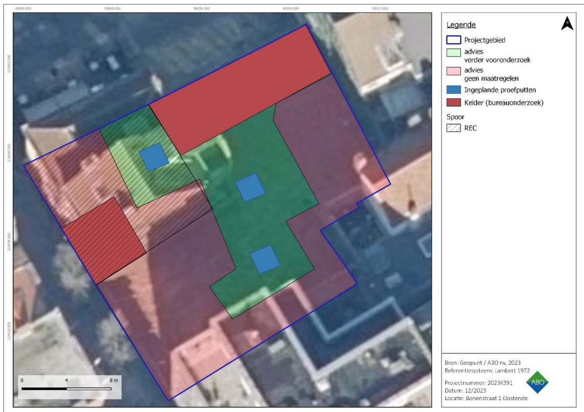
Figuur 11: Gekende en vastgestelde verstoringen (kelders) tijdens het proefputtenonderzoek.
