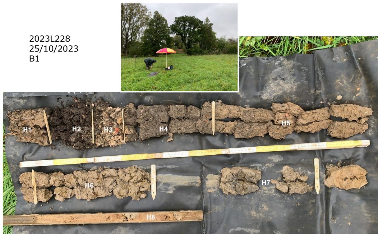
Figuur 12: Boring 5 met aanduiding van de horizonten (Raakvlak)
