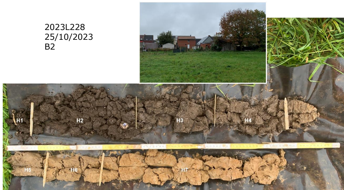
Figuur 9: Boring 2 met aanduiding van de horizonten (Raakvlak)
