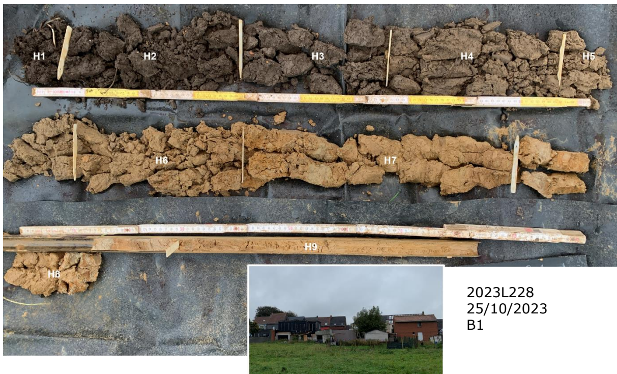
Figuur 8: Boring 1 met aanduiding van de horizonten (Raakvlak)
