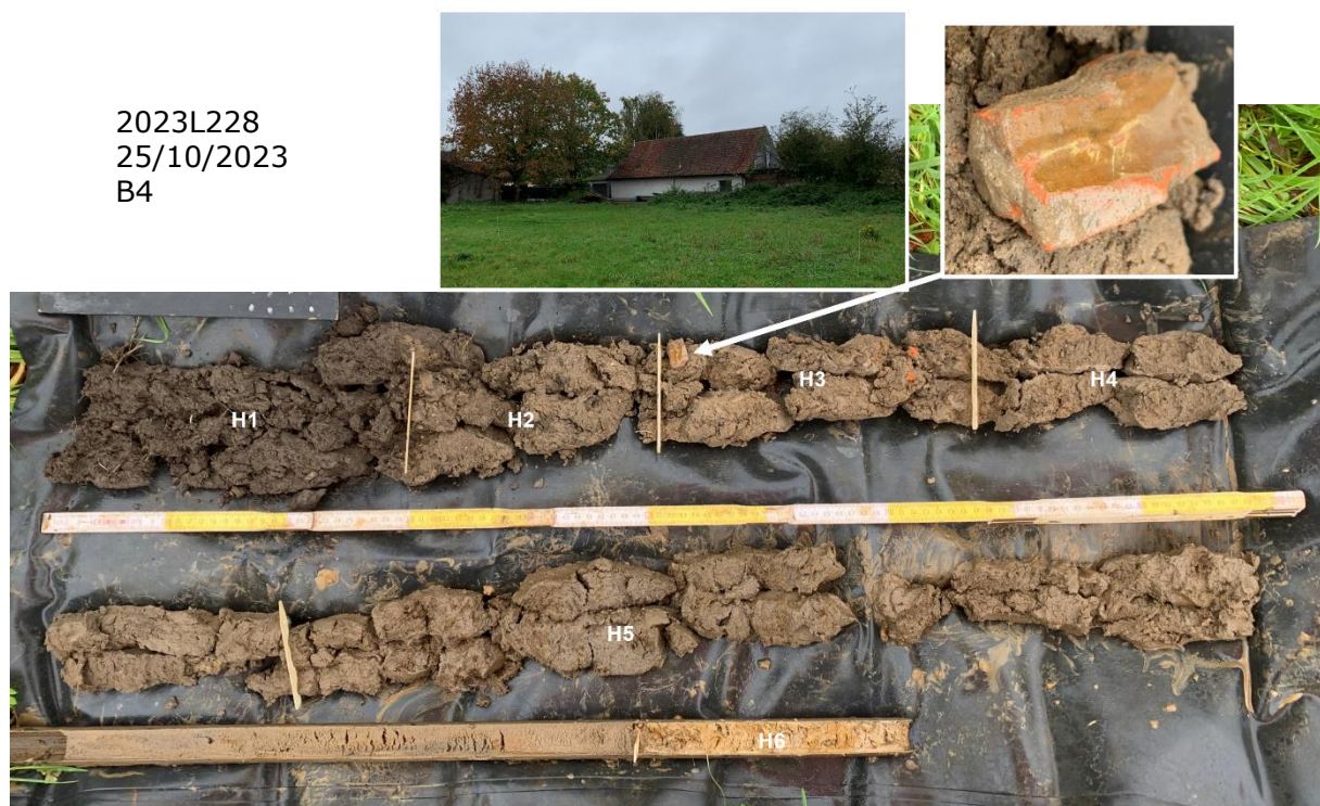
Figuur 11: Boring 4 met aanduiding van de horizonten (Raakvlak)
