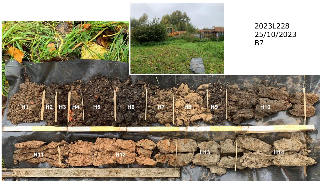
Figuur 15: Boring 7 met aanduiding van de horizonten (Raakvlak)
