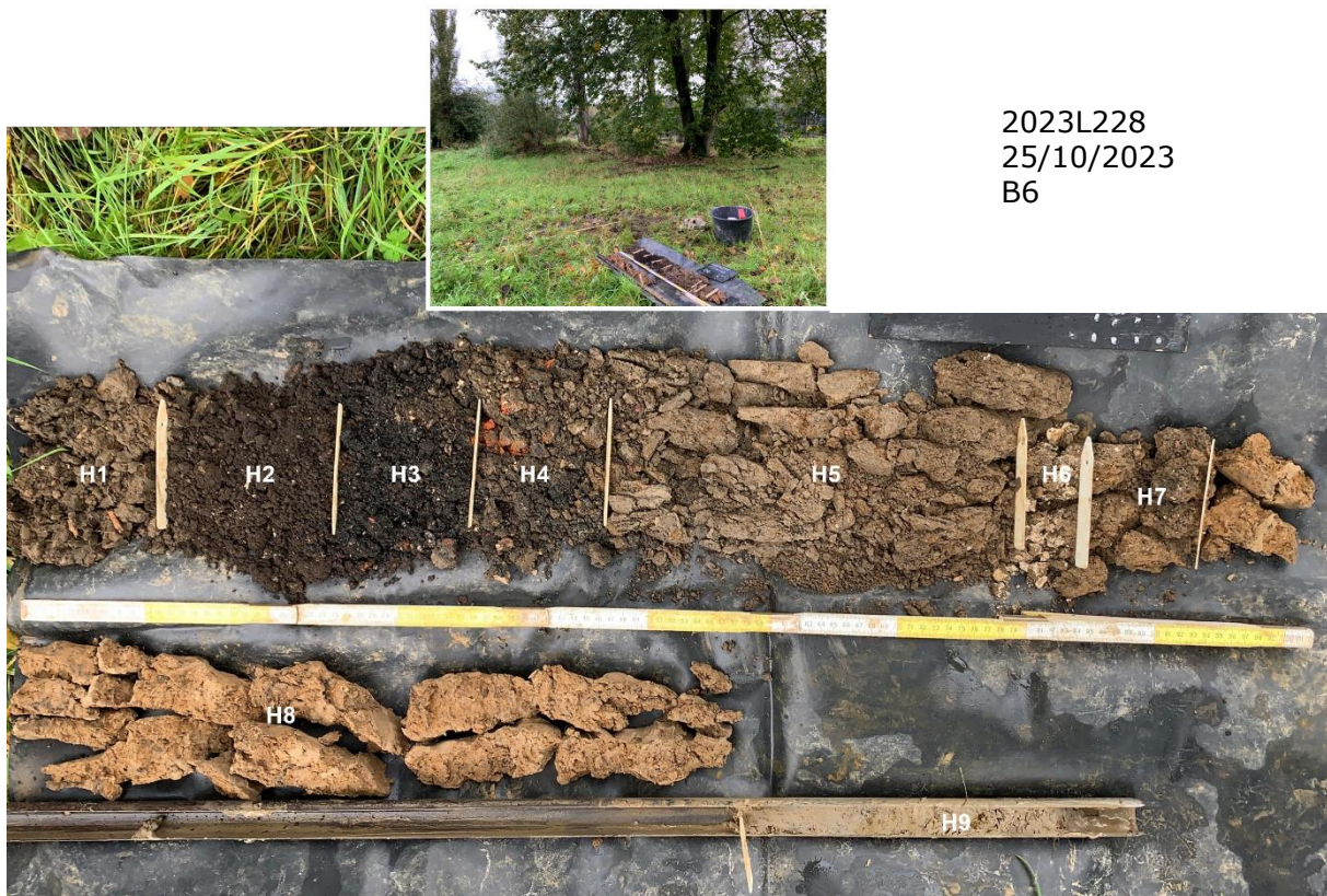
Figuur 14: Boring 6 met aanduiding van de horizonten (Raakvlak)
