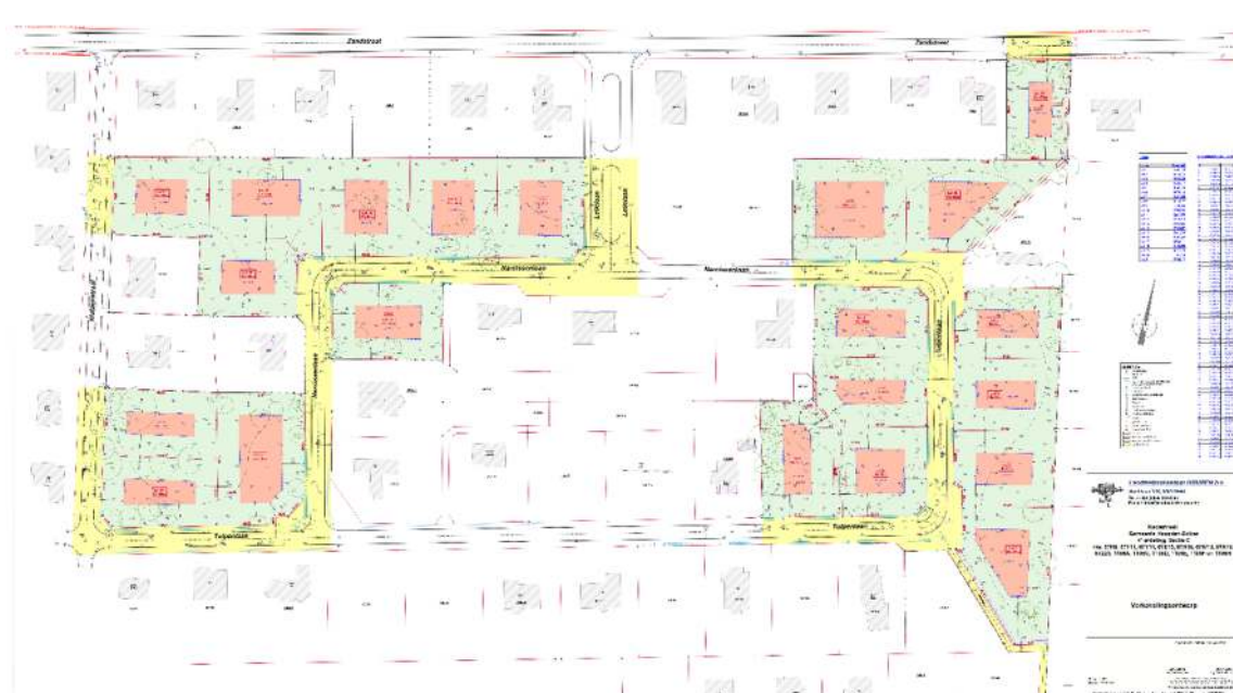
Afbeelding 3.6.1: verkavelingsplan van de toekomstige situatie. In de groene zones is het niet toegelaten om te bouwen, een constructie op te trekken of om een grasvlakte te maken. Daar mogen enkel hoogstammige bomen geplant worden. De bouwwerken en zone voor achtertuin zijn beperkt tot de rode blokken.
