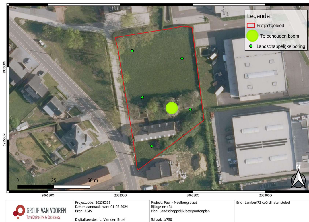
Fig. 2.6: Voorstel boorpuntenplan op de meest recente luchtfoto.
