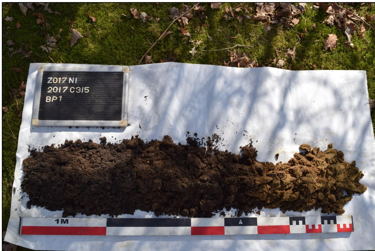
Afb. 28: BP 1 met horizonten Ap1 – Ap2 – Cg (Bron: Aron bvba, dd. 23/03/2017, 2017C315)
