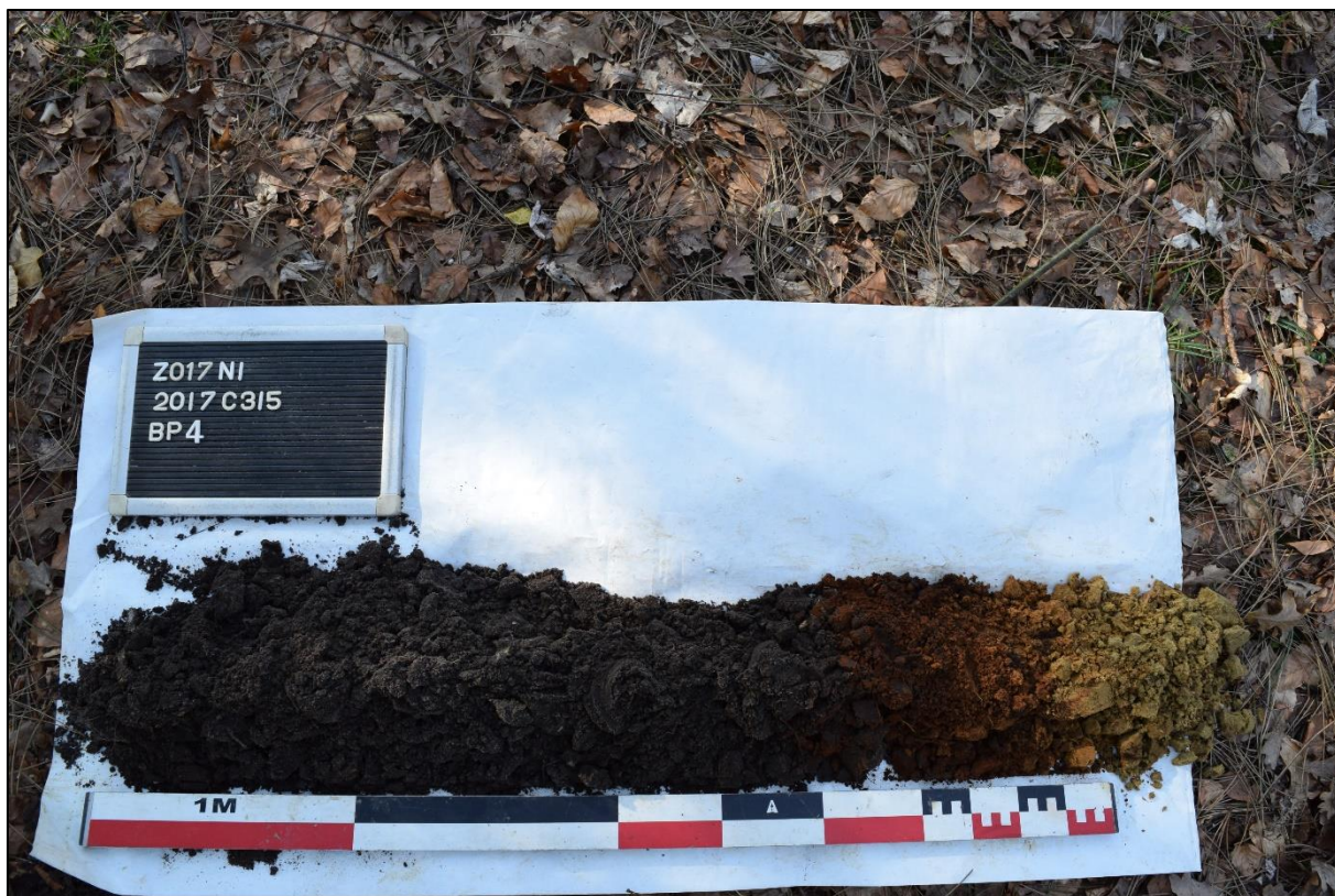
Afb. 31: BP 4 met horizonten Ap1 – Ap2' – Bs – Cg (Bron: Aron bvba, dd. 23/03/2017, 2017C315)
