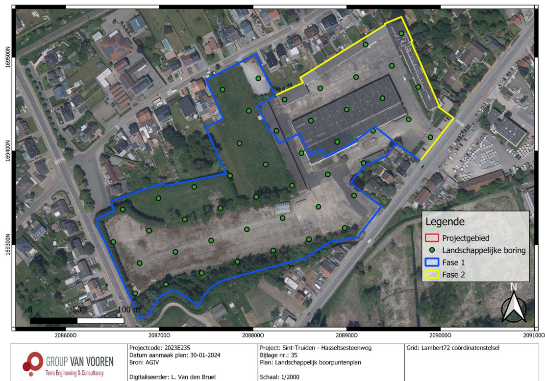
Fig. 2.8: Voorstel boorpuntenplan op de meest recente luchtfoto.
