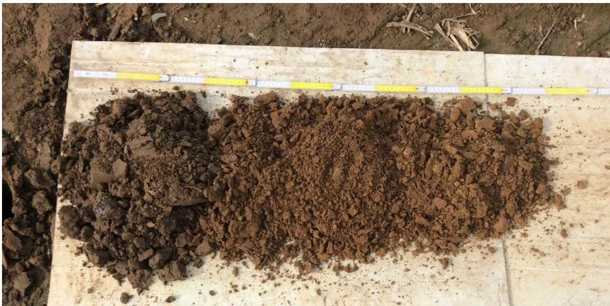
Figuur 14: Boring B65 met Ap-Bt-C- bodemopbouw
