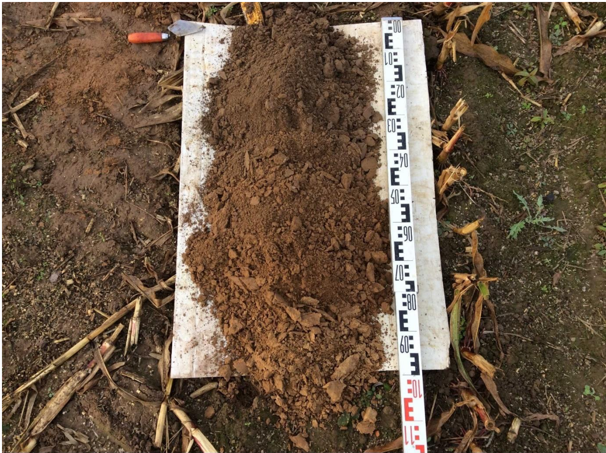
Figuur 11: Voorbeeld van een geregistreerde boring (B55) dor middel van een Edelmanboor op het terrein.
