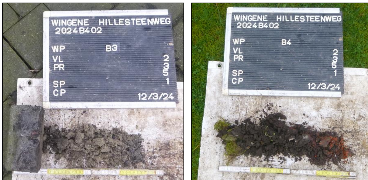
Figuur 15: Boorprofielen bij gestaakte boring 3 en 4 (ABO nv 2024)
